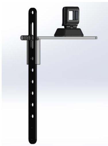
Figura 61 Soporte de la cámara con altura variable
