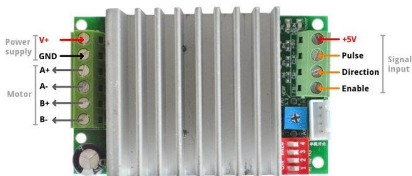
Figura 77 Distribución de pines Driver BL - TB6560 - V1.2 – 4.5A Fuente: (DIY Projects, 2018)
