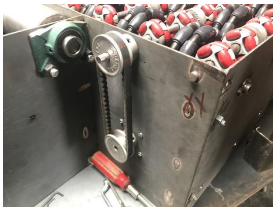
Figura 58 Sistema de transmisión de Motor (14 kg.cm) – ruedas 48 mm
