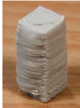
Figura 15 Deformación de capas en una pieza
