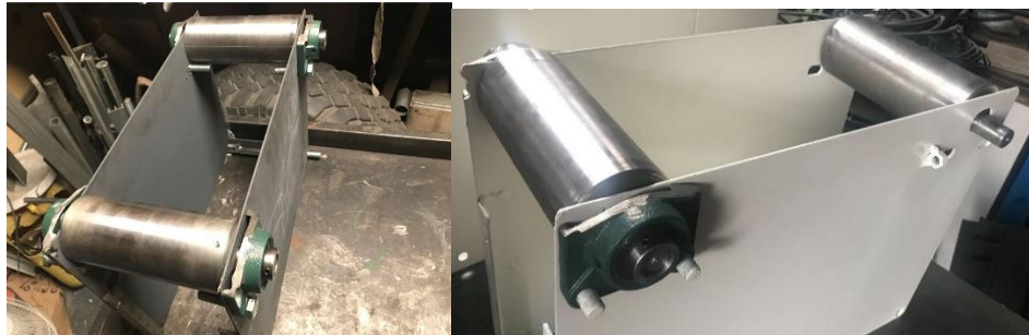
Figura 69 Base de la banda transportadora
