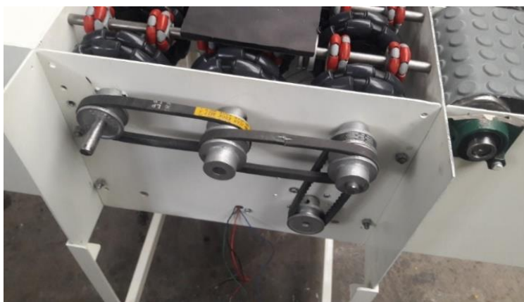
Figura 59 Sistema de transmisión de Motor (19 kg.cm) – ruedas 125 mm
