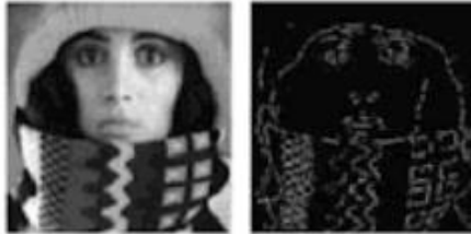
Figura 27 Filtro Canny aplicado en una imagen
