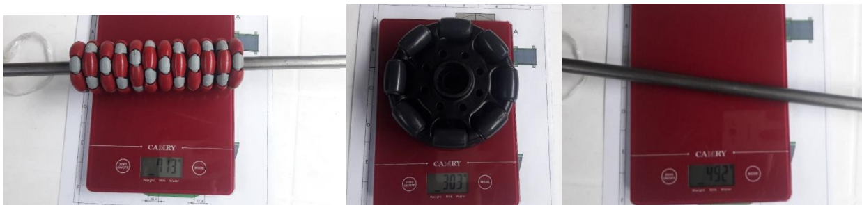
Figura 47 Peso de ruedas omnidireccionales y sus ejes
