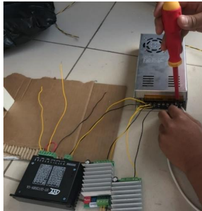
Figura 83 Conexión drivers – fuente de alimentación
