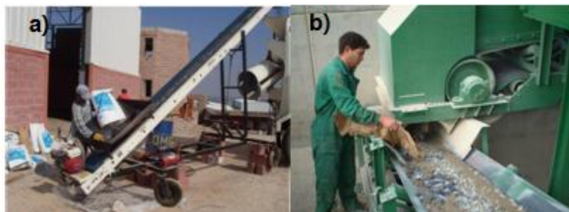
Figura 22. Mezclado de fibras de acero: a) en obra – b) en planta Fuente: (Badell, 2015)
