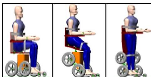
**Figura 5.** Transición hacia una posición vertical de dos ruedas.
