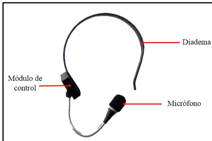
*Figura 75.* Componentes del control por voz.
