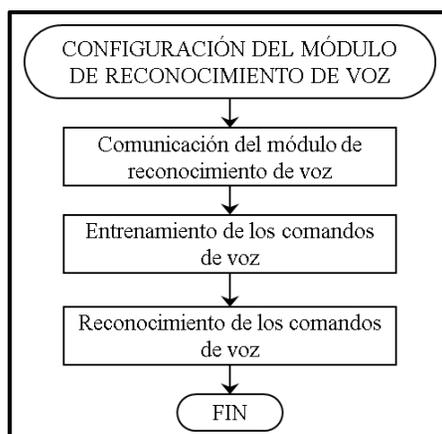
**Figura 47.** Configuración del módulo de reconocimiento de voz.
