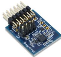
Figura 12 Giroscopio de 3 ejes
