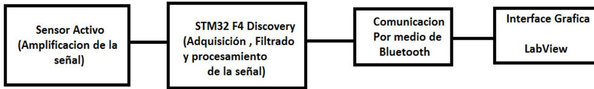
**Figura 2.** Diagrama de Bloques del proceso de las señales Bioeléctricas
