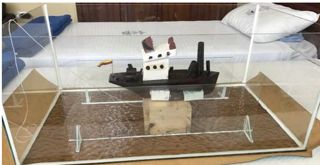
Figura 18 Maqueta sobre el efecto Squat.
