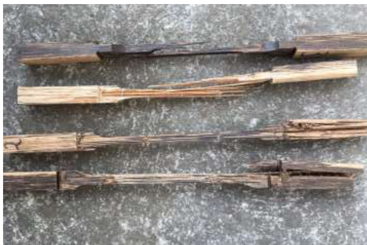
Figura 35. Probetas ensayo tracción después del ensayo.
