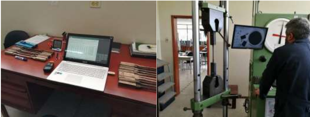
Figura 23. Equipos y probetas, máquina de ensayos universales AMSLER.
