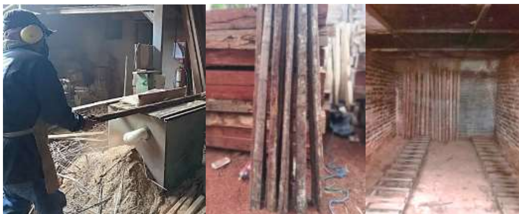
Figura 18. Cortado de trozas, secado al ambiente y secado al horno.
