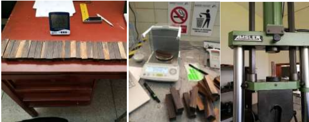
Figura 25. Equipos y probetas, probeta ubicada en el centro de los topes cilíndricos.
