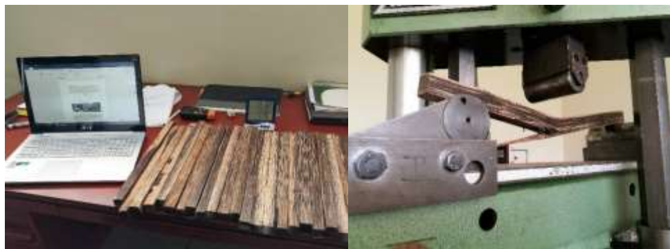
Figura 29. Equipos, probetas, ensayo flexión estático.
