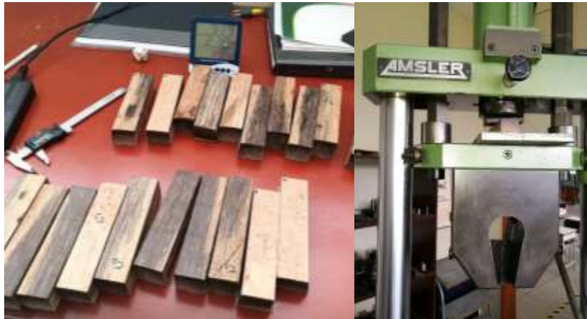
Figura 27. Probetas, placa metálica ubicada en la superficie radial de la probeta.
