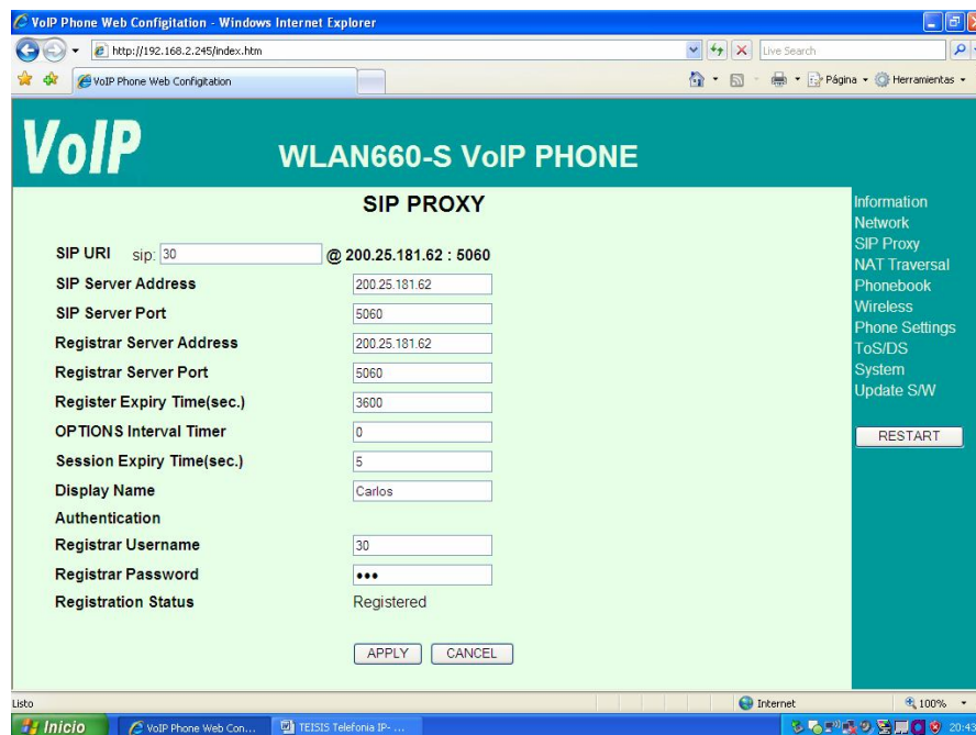
Figura. 4.11. Pagina Wi-Fi Phone – Configuración de SIP PROXY
