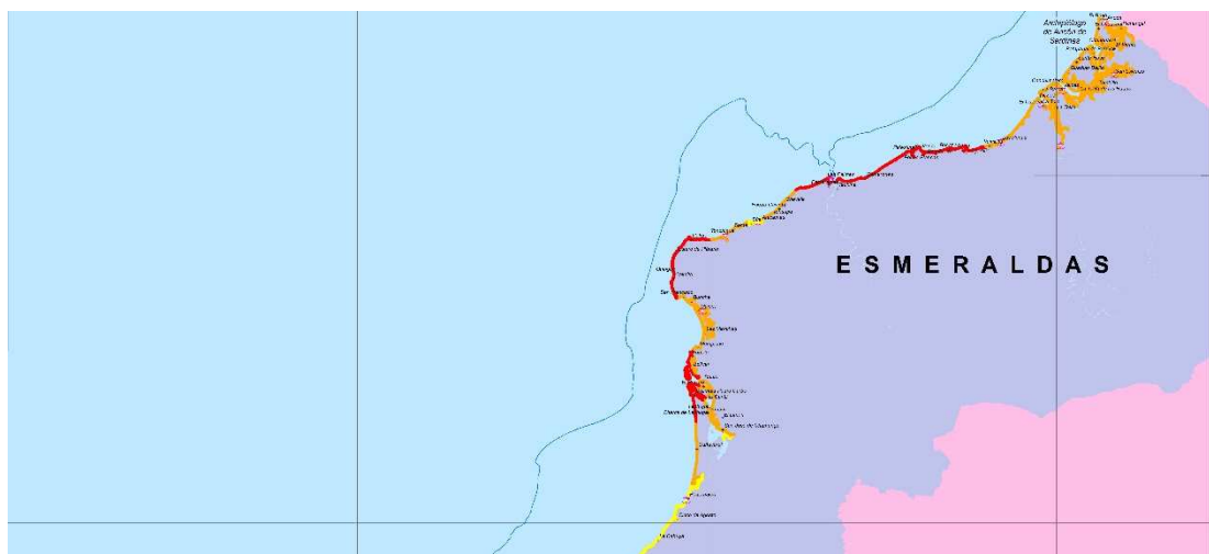
Figura 21 Mapa de altura aproximada de ola por tsunami (Zona Norte) Fuente: Instituto Oceanográfico de la Armada
