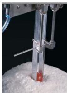
Figura 11 Pinza desarrollada para la manipulación de elementos delicados
