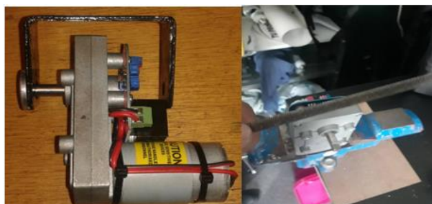
Figura 85 Reducción de eje del motor ASMC03B para el acople
