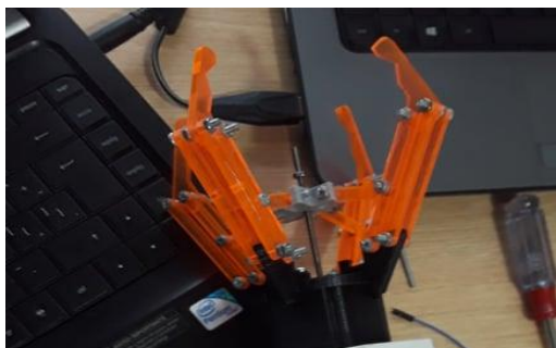
Figura 88 Manipulador realizado en corte láser
