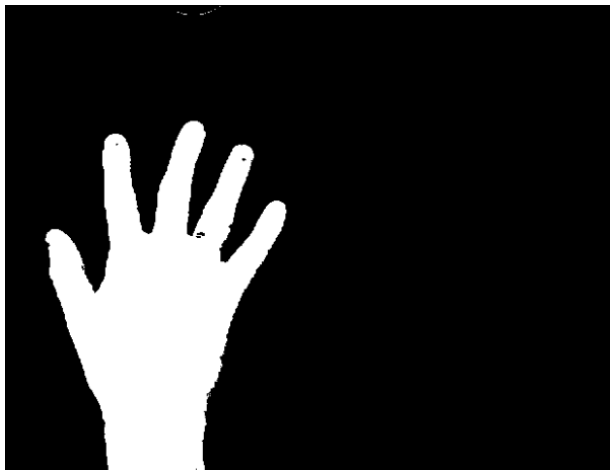
Figura 59 Máscara en formato HSV obtenido con la Kinect
