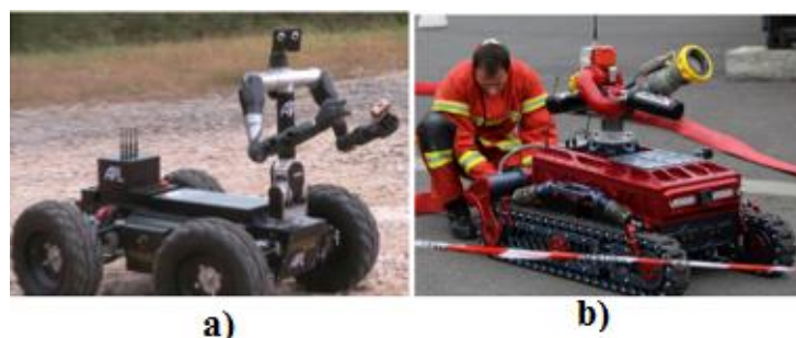
Figura 8 Aplicación de robots híbridos. a) Robo Sally desactivador de b) Robot extintor Scarab Vulcain.
