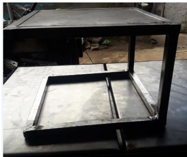
Figura 77 Soldado de los perfiles para conformar la estructura base
