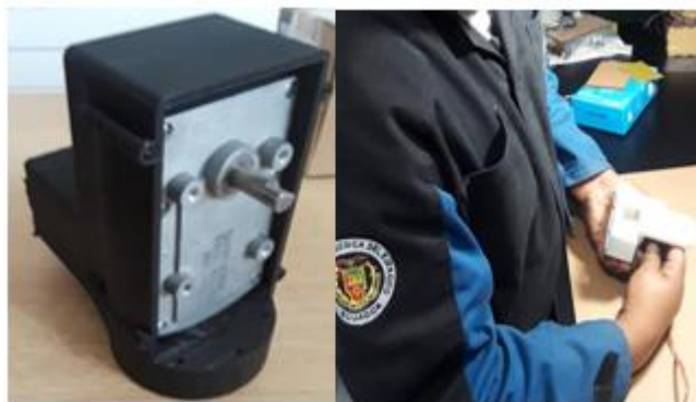
Figura 83 Probar que los motores encajen perfectamente
