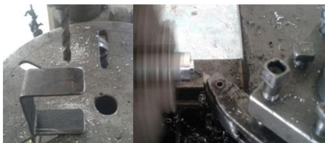
Figura 84 Maquinado de los acoples de los motores de la base ASMC03B
