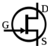
**Figura 30** Transistor FET de canal N
