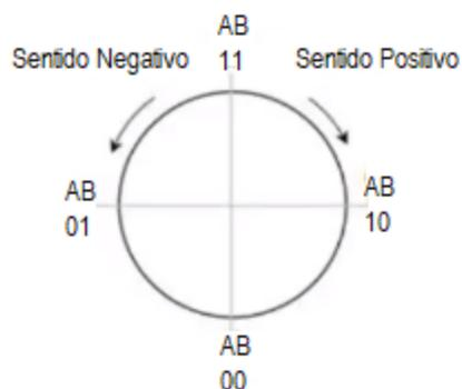
**Figura 33** Esquema gráfico del sentido de giro del eje de un motor
