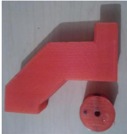
**Figura 14** Pieza de acople impresa en 3D
