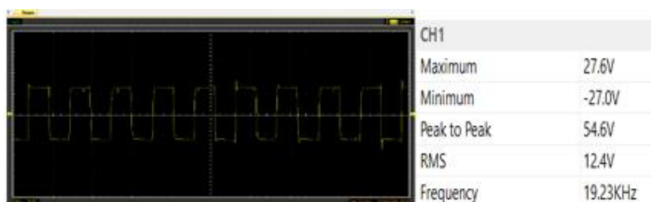
Figura 30. Forma de onda a la salida del puente H
