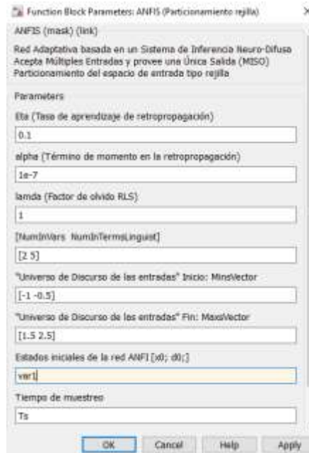
Figura 77. Configuración de bloque ANFIS para el control del sistema (lazo cerrado)
