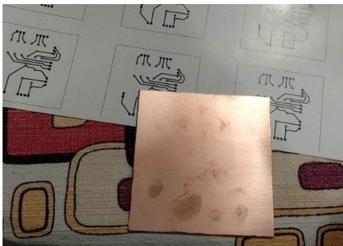
Figura 73. Baquelita y circuito impreso en papel termotransferible
