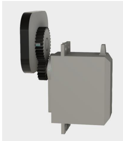
Figura 31. Mecanismo pie acople con engranes Fuente: (Autodesk, 2018)
