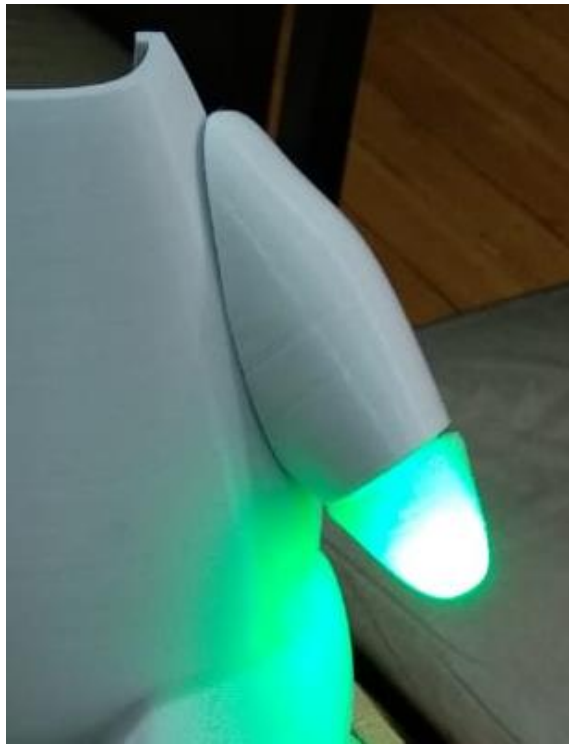
Figura 71. Colocación mano flexible en esqueleto y brazo
