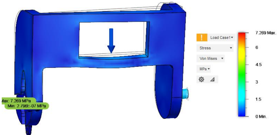
Figura 48. Simulación Esfuerzos Von Mises – Soporte Cara Fuente: (Autodesk, 2018)
