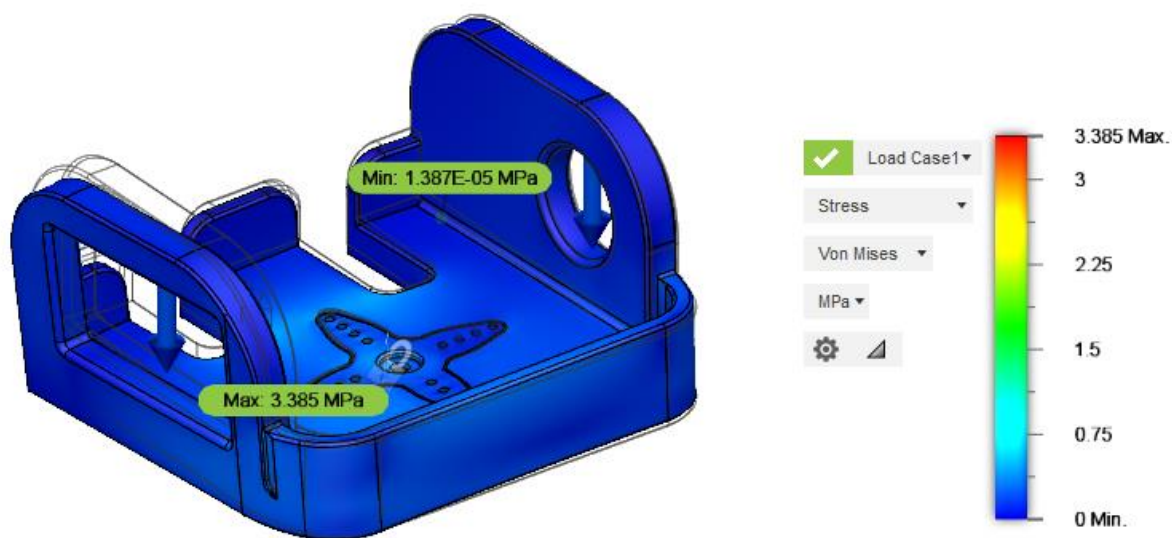
Figura 44. Simulación Esfuerzo Von Mises – Soporte Cabeza Fuente: (Autodesk, 2018)
