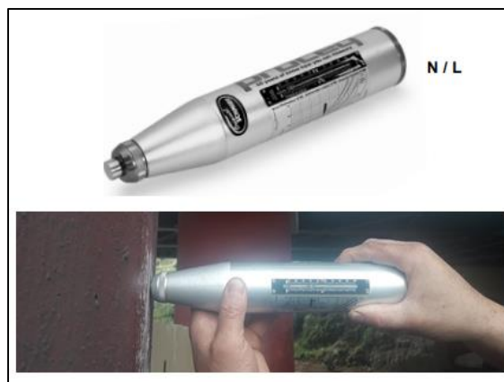
Figura 45. Martillo Original Schmidt Proceq Modelo N/L.
