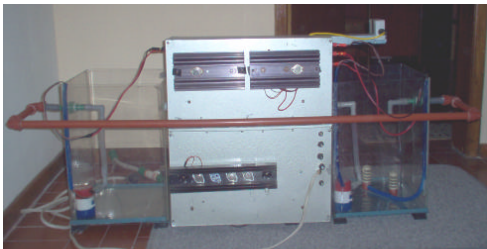
Figura 1.5. Tubería de retorno del Sistema de entrenamiento CPTS-1
