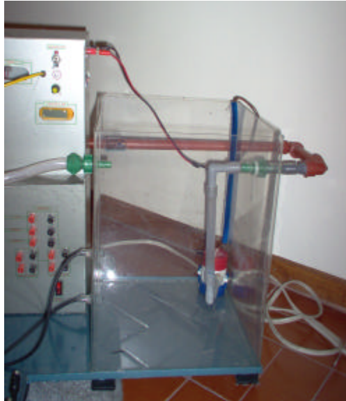
Figura 1.4. Tanque derecho del Sistema de entrenamiento CPTS-1
