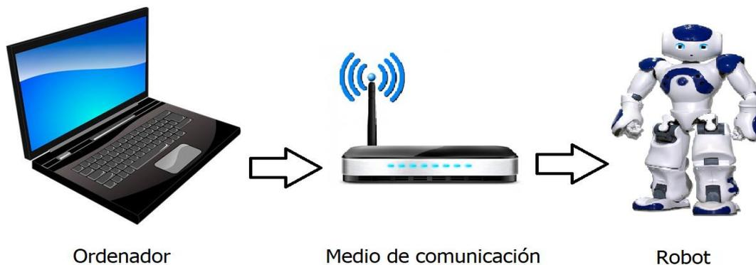
**Figura 17.** Forma de conexión ordenador-robot.
