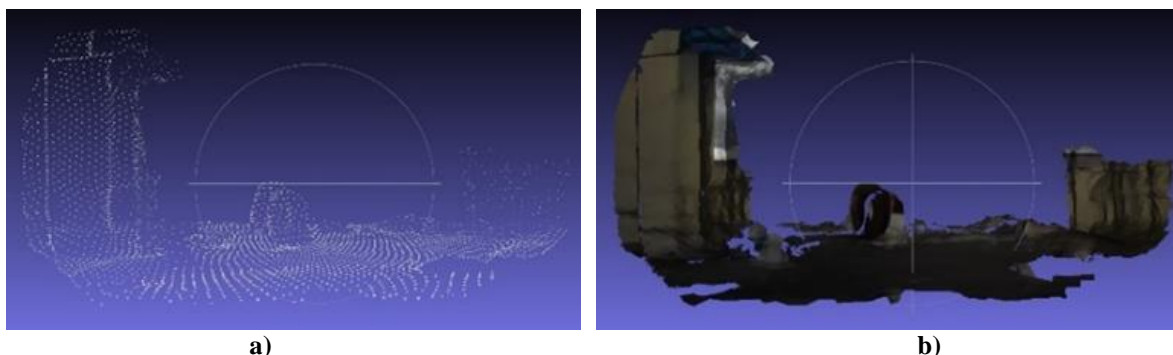
Figura 181. Proceso de reconstrucción del mapa usando resolución HD720 con calidad de percepción de profundidad QUALITY y un filtro de tipo alto. a) Nube de puntos b) Imagen texturizada con efectos de iluminación.
