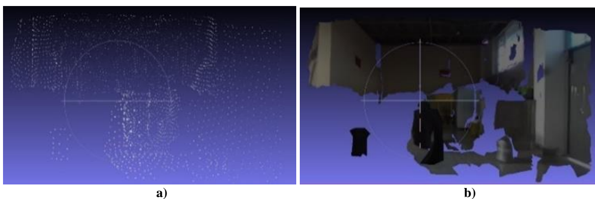
Figura 169. Proceso de reconstrucción del mapa usando resolución VGA con calidad de percepción de profundidad QUALITY y un filtro de tipo alto. a) Nube de puntos b) Imagen texturizada con efectos de iluminación.
