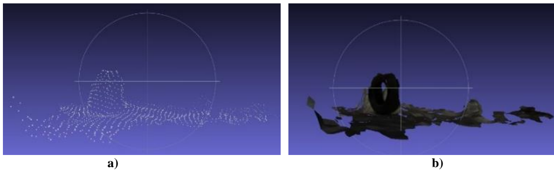
Figura 179. Proceso de reconstrucción del mapa usando resolución HD720 con calidad de percepción de profundidad PERFORMANCE y un filtro de tipo alto. a) Nube de puntos b) Imagen texturizada con efectos de iluminación.
