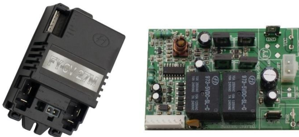
Figura 72. Caja de control y recepción por Control remoto FY 6V 27mhz
