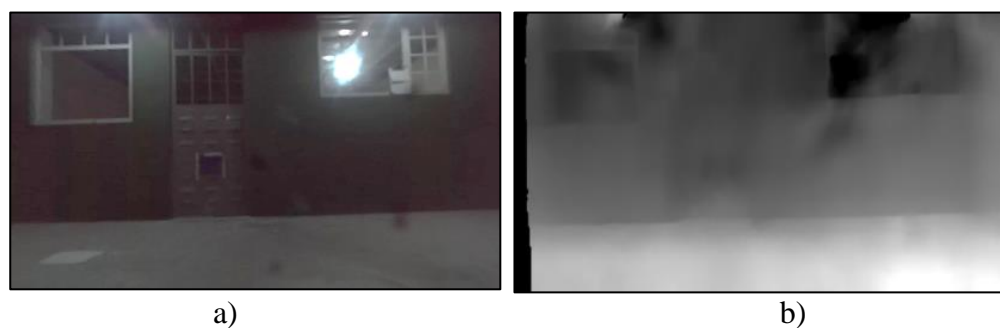
Figura 61. Entorno de prueba para mediciones de distancia en la noche a) imagen de lente izquierdo b) mapa de profundidad
