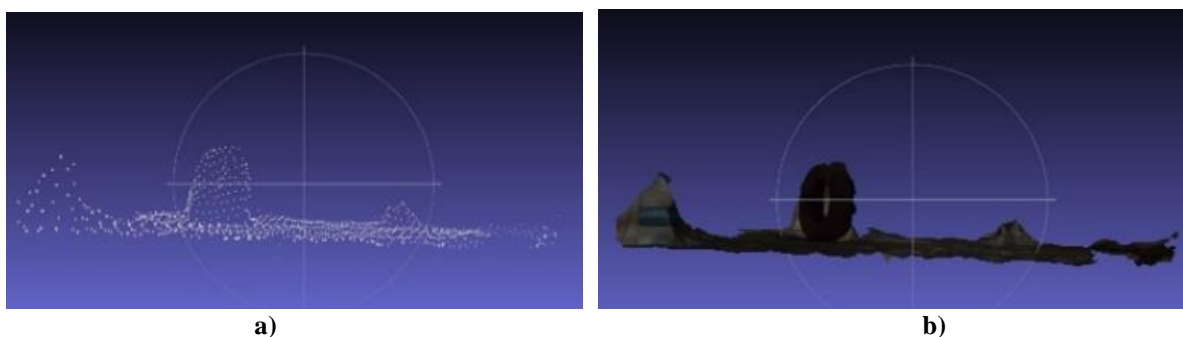
Figura 182. Proceso de reconstrucción del mapa usando resolución HD1080 con calidad de percepción de profundidad PERFORMANCE y un filtro de tipo alto. a) Nube de puntos b) Imagen texturizada con efectos de iluminación.
