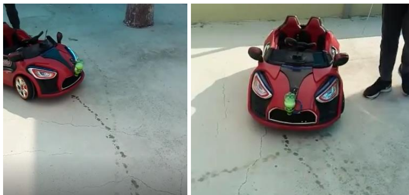
Figura 130. Determinación de radio de giro y de ángulos máximos de curvatura
