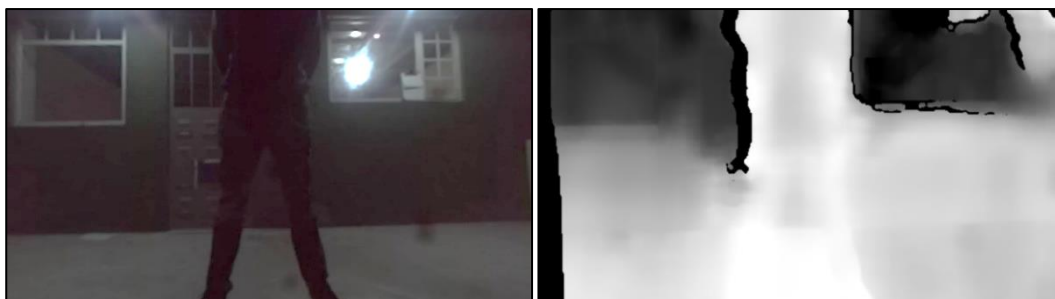
Figura 63. Prueba con obstaculo en frente a 1.1 m de distancia en la noche a) imagen de lente izquierdo b) mapa de profundidad
