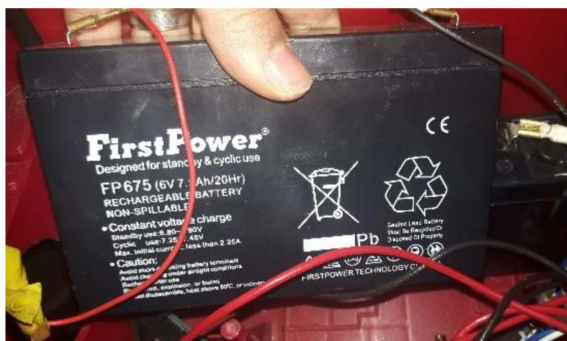
Figura 74. Batería recargable FirstPower FP675.
