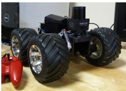
Figura 46. Vehículo para prueba en la generación de mapas 2D
