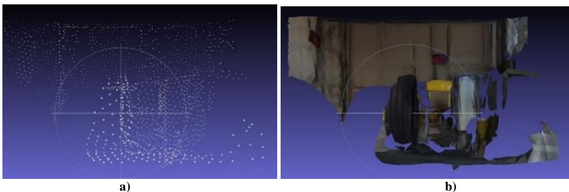
Figura 175. Proceso de reconstrucción del mapa usando resolución HD1080 con calidad de percepción de profundidad QUALITY y un filtro de tipo alto. a) Nube de puntos b) Imagen texturizada con efectos de iluminación.
