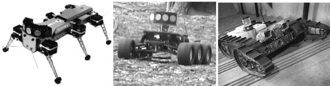
Figura 3. Sistemas de locomoción - Patas (Hermes), Ruedas (Journey), Cadenas (Scour) Fuente: (Bambino, 2008)
