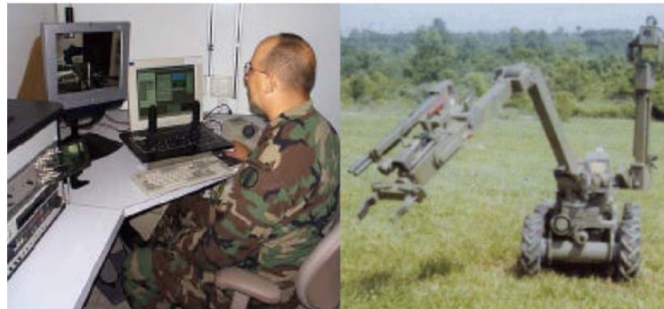
Figura 1. UGV Teleoperado - Andros Wolverine Fuente: (Correa A. C., 2005)
