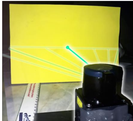
Figura 35. Medición con el sensor UST-20LX
