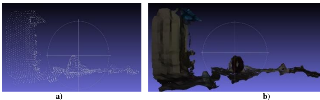
Figura 176. Proceso de reconstrucción del mapa usando resolución VGA con calidad de percepción de profundidad PERFORMANCE y un filtro de tipo alto. a) Nube de puntos b) Imagen texturizada con efectos de iluminación.
