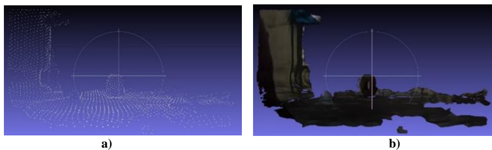
Figura 177. Proceso de reconstrucción del mapa usando resolución VGA con calidad de percepción de profundidad MEDIUM y un filtro de tipo alto. a) Nube de puntos b) Imagen texturizada con efectos de iluminación.
