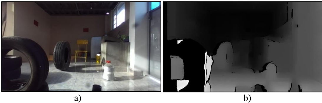
Figura 51. Proceso de ejecución de estéreo cámara ZED a) imagen de lente izquierdo b) mapa de profundidad
