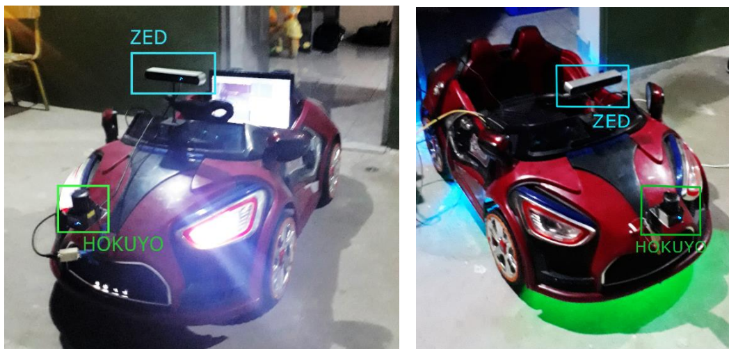
Figura 79. Resultado final del montaje de todos los elementos sobre el vehículo
