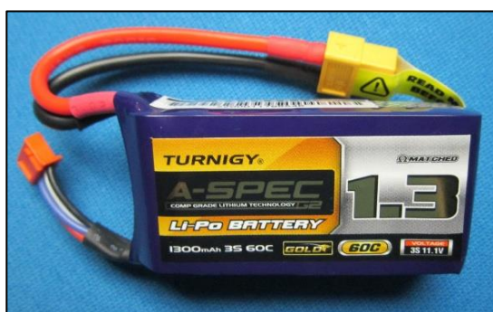
Figura 33. Batería Turnigy LIPO, 11.1VDC - 1300mAh
