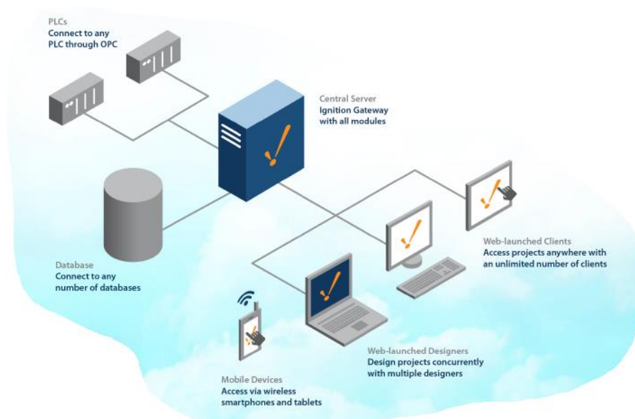
Figura 14. Estructura de Ignition
