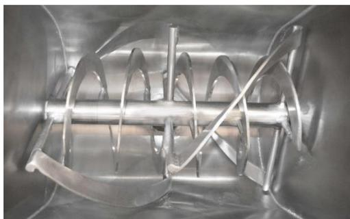
**Figura 5.** Mezcladora Helicoidal
