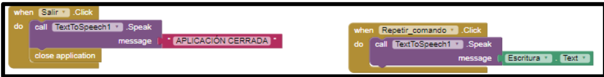
Figura 81. Bloque para cerrar la aplicación
