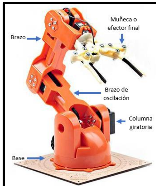
Figura 17. Partes del Brazo Robótico
