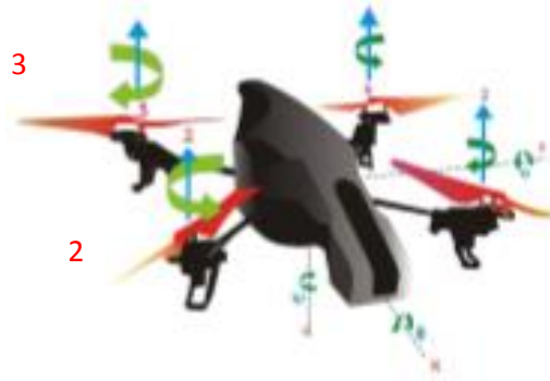
Figura 8. Movimientos básicos de dron: movimiento hacia la derecha Fuente: (Casanova , 2015)
