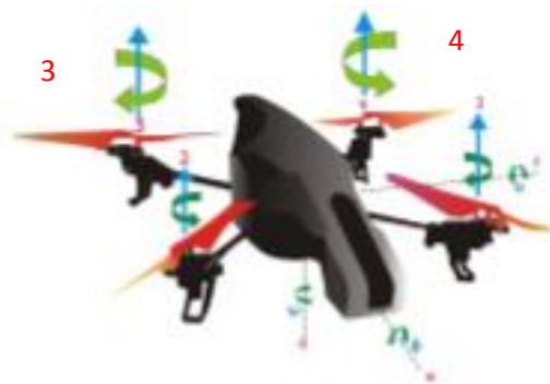
Figura 5. Movimientos básicos de dron: movimiento hacia adelante Fuente: (Casanova , 2015)
