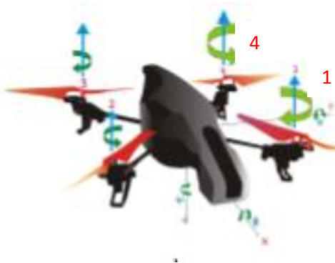
Figura 7. Movimientos básicos de dron: movimiento hacia la derecha Fuente: (Casanova , 2015)
