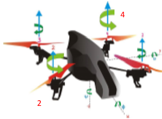
Figura 10. Movimientos básicos de dron: giro hacia la izquierda Fuente: (Casanova , 2015)
