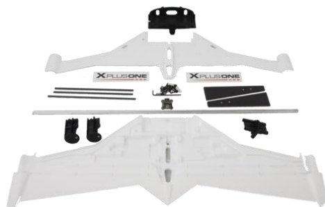
Figura 11. Estructura del quadrotor xcraft plus One, material: Poliestireno expandido (EPS) Fuente: (Xcraft, 2017)
