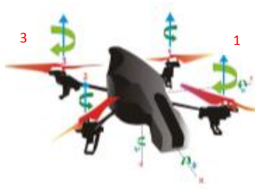
Figura 9. Movimientos básicos de dron: giro hacia la derecha Fuente: (Casanova , 2015)
