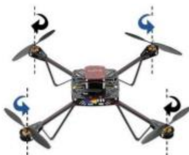
Figura 4. Reacción de torques en cada motor de un quadrotor Fuente: (Pestana M. J., Sánchez, Saripalli, & Campoy, 2017)
