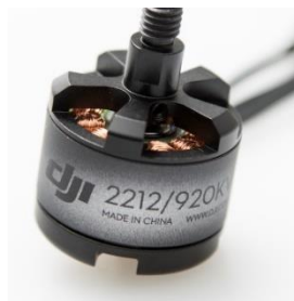
Figura 12. Motor del quadrotor DJI Fuente: (DJI, 2018)
