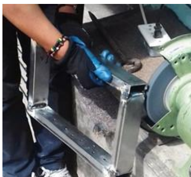
a) Construcción de caja
