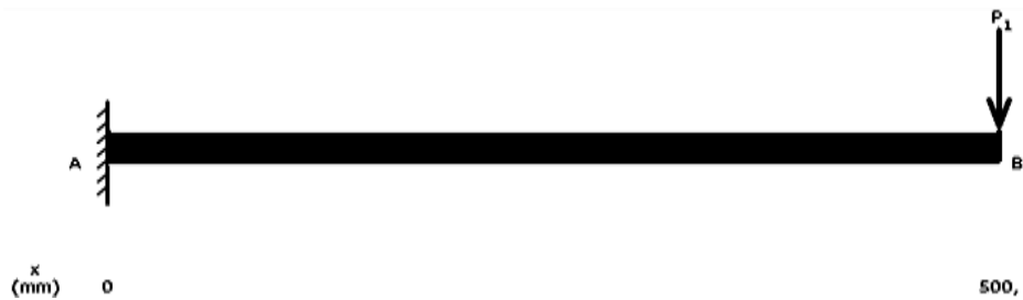
Figura 23. Diagrama cuerpo libre del sistema de visión artificial.
