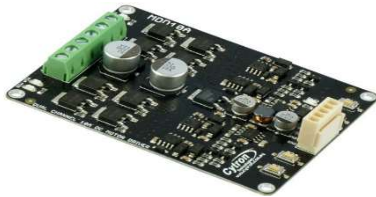
Figura 33. Controlador de motor CC de doble canal Cytron Fuente: (makerselectronics, s.f.)
