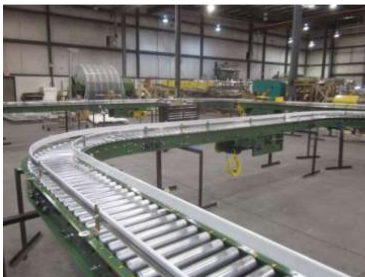
Figura 3. Transportador de rodillos. Fuente: (BOLETININDUSTRIAL.COM, 2018)
