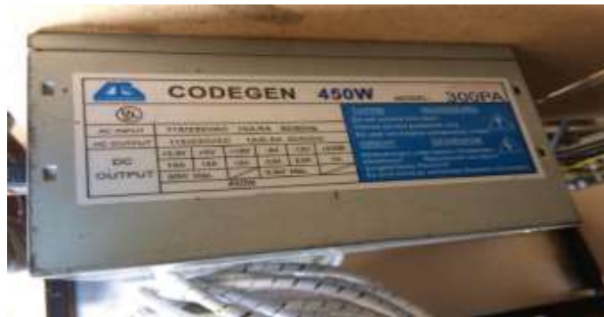
Figura 48. Fuente de poder CODEGEN 300PA Fuente: (Linio, s.f)
