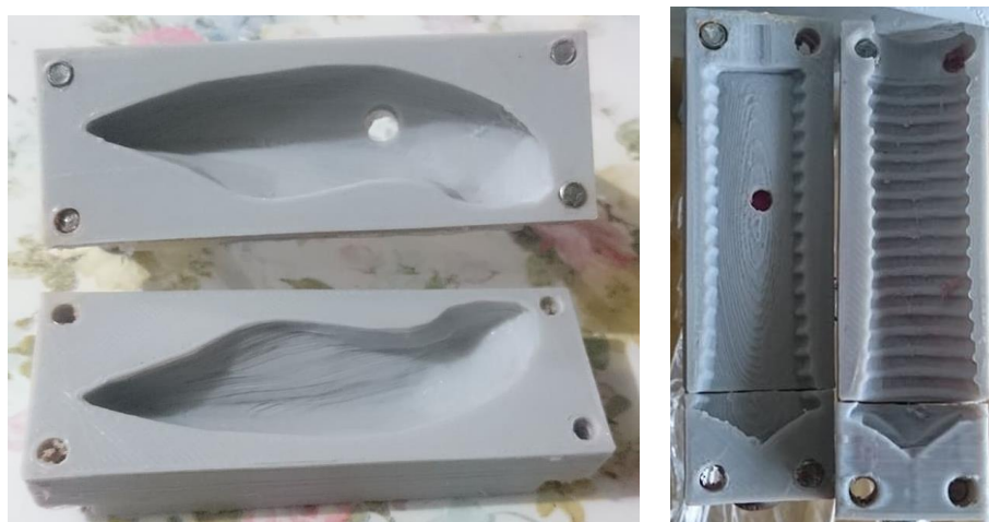
Figura 67. a) Moldes de la lengua, b) Moldes de la tráquea
