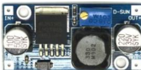
Figura 21. Convertidor de voltaje DC-DC Fuente: (Electronilab, 2017)
