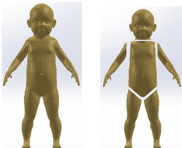
Figura 29. a) Maniquí en un software CAD, b) Cortes del diseño CAD del simulador
