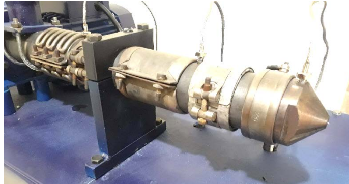
Figura 53. Disposición de resistencias y termopares
