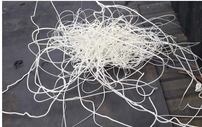
Figura 68. ABS extruido a 180°C
