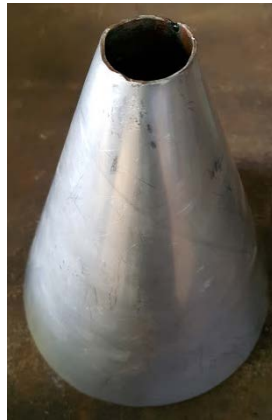
Figura 50. Construcción de la tolva
