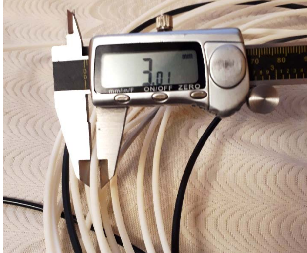
Figura 69. ABS extruido a 210°C
