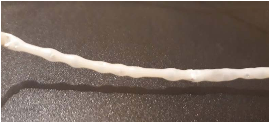
Figura 70. ABS extruido a 240°C
