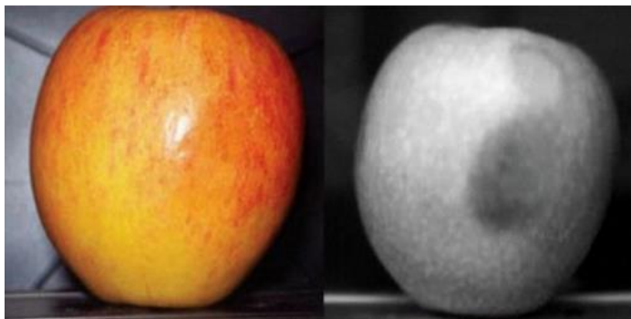
Figura 4. Detección de defectos mediante Rayos X Fuente:(Giró, 2017)
