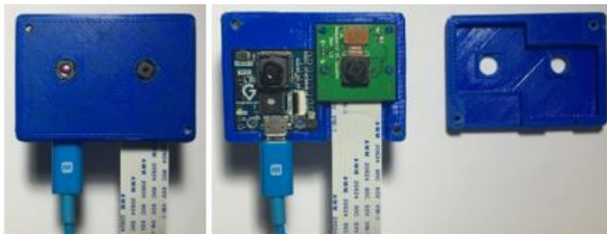
Figura 32. Cámaras montadas sobre el cobertor
