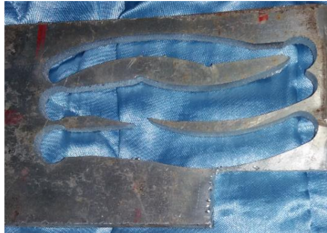
Figura 88. Resultado del corte en una plancha de 5 mm de espesor
