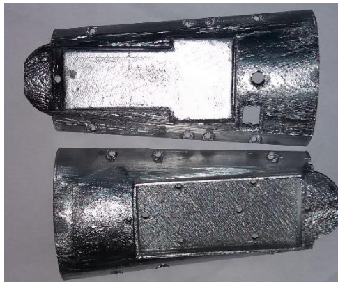
Figura 85. Pintura base para el masillado en las cubiertas
