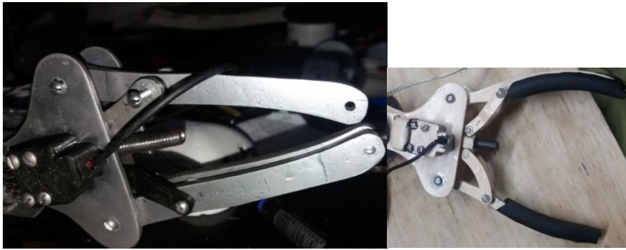
Figura 96. Modelo tipo Gripper físico en aluminio
