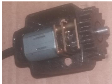
Figura 98. Micro motor de 1 a 100 de 1.7 kg·cm
