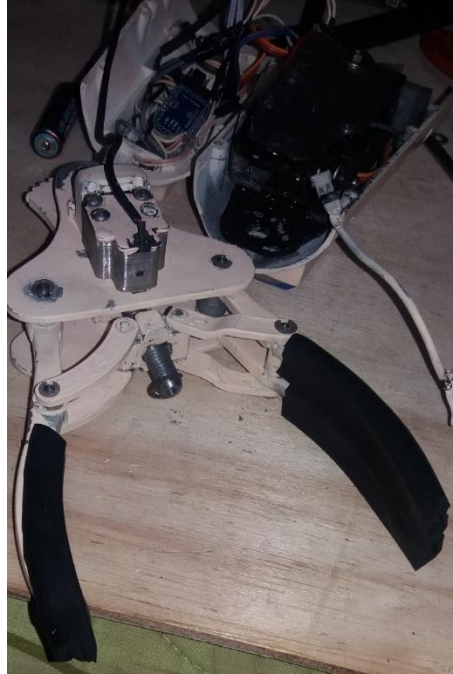
Figura 102 Instalacion de la cubierta en los dedos
