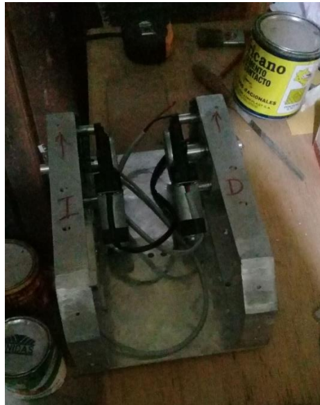
Figura 42. Montaje de motores de tracción
