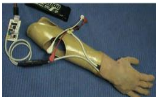
Figura 11. Prótesis de mano eléctrica.
