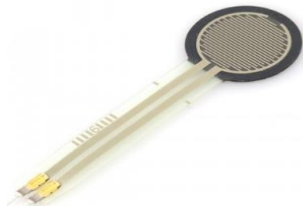
Figura 22. Sensor de fuerza resistivo (FSR).
