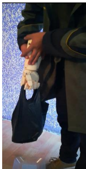
Figura 86 Prueba de agarre en gancho
