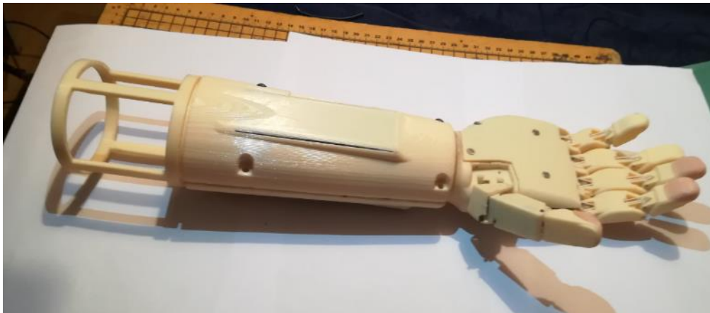
Figura 84. Ensamblaje final del prototipo de prótesis de mano biónica.
