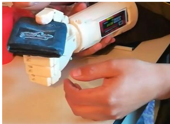
Figura 89. Prueba de agarre lateral
