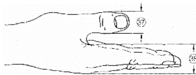
Figura 28. Antropometría de la mano según la norma DIN 33402(Parte 2)
