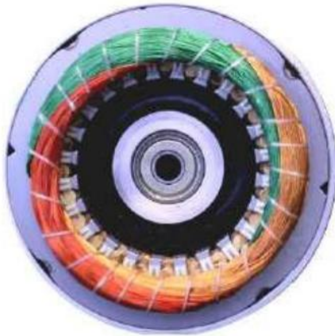
Figura 6. Bobinado del moto generador
