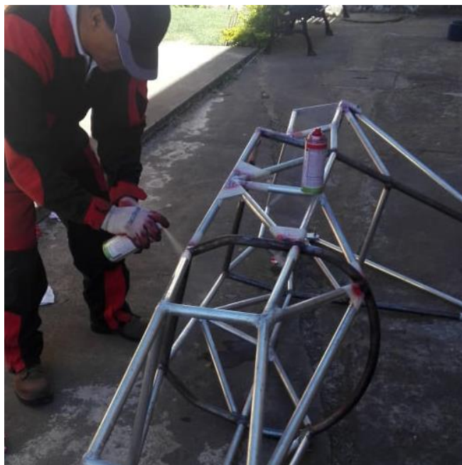
Figura 110. Colocación del líquido penetrante
