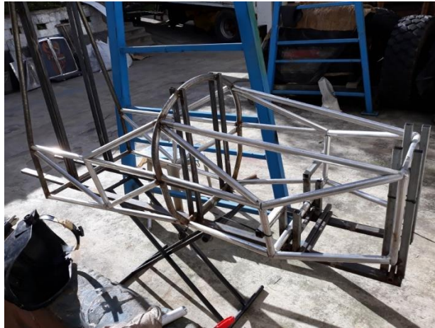
Figura 97. Ensamble de los tubos en la estructura base
