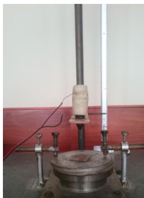
Figura 75. Máquina de impacto por caída de dardo
