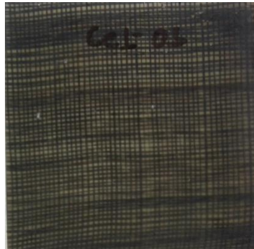
Figura 72. Probeta de impacto con una capa de crin
