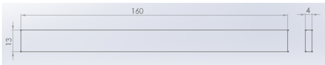
Figura 58. Medidas probeta de flexión ASTM D7264/D7264M-15
