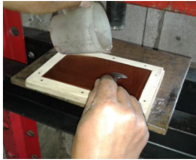
Figura 66. Colocación matriz poliéster sin refuerzo en el molde
