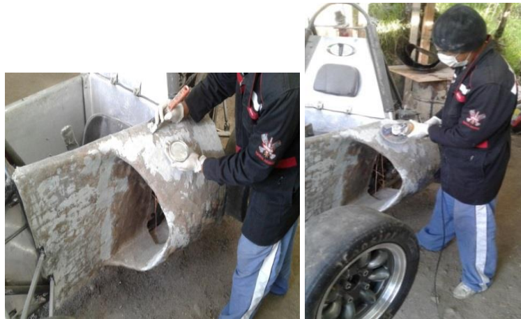
Figura 105. Recubrimiento de los moldes de la parte lateral
