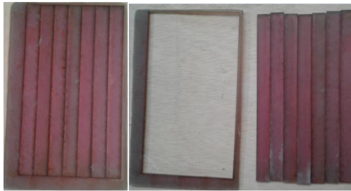
Figura 71. Obtención probetas de matriz poliéster de flexión
