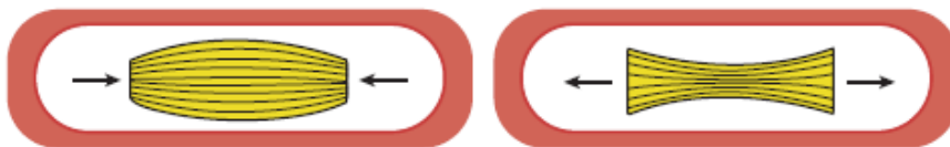
Figura 18. Diferentes tipos de cargas que debe soportar la matriz
