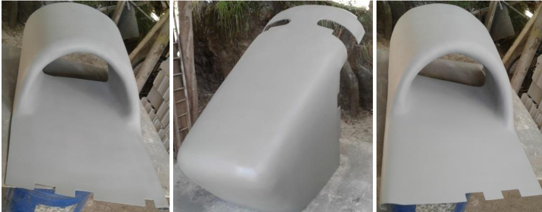
Figura 115. Piezas terminadas de dar la pintura base y lijar
