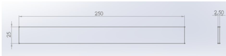
Figura 55. Medidas probeta de tracción ASTM D3039/D3039M-17
