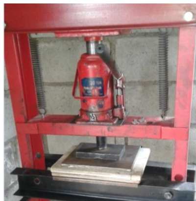
Figura 67. Compresión matriz poliéster sin refuerzo
