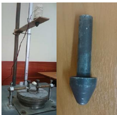
Figura 88. Equipo para ensayo de impacto por caída libre de dardo y dardo normalizado para la configuración FB
