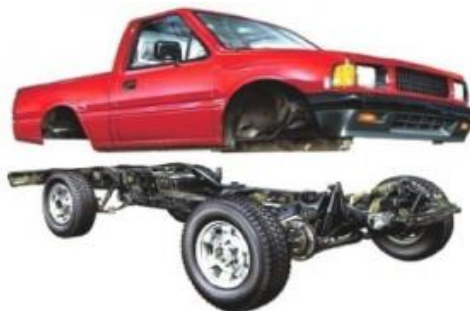
Figura 5. Vehículo con carrocería y chasis independiente
