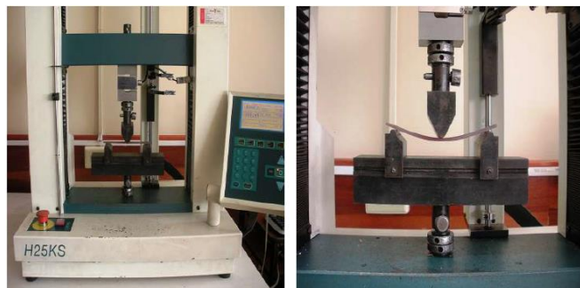
Figura 82. Ensayo de flexión probeta grupo Re
