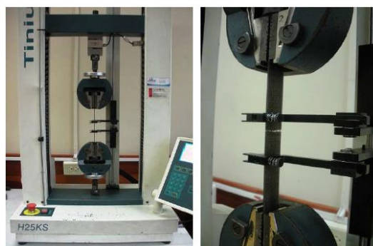
Figura 76. Ensayo tracción probeta grupo Ce1
