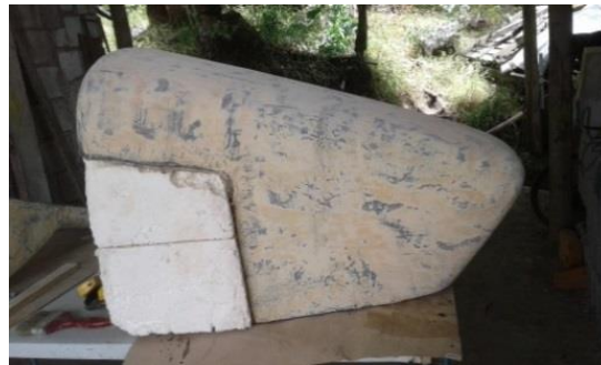
Figura 112. Curado de las capas y primera capa de masilla
