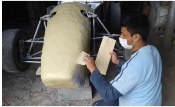
Figura 110. Capa de masilla gruesa sobre la superficie
