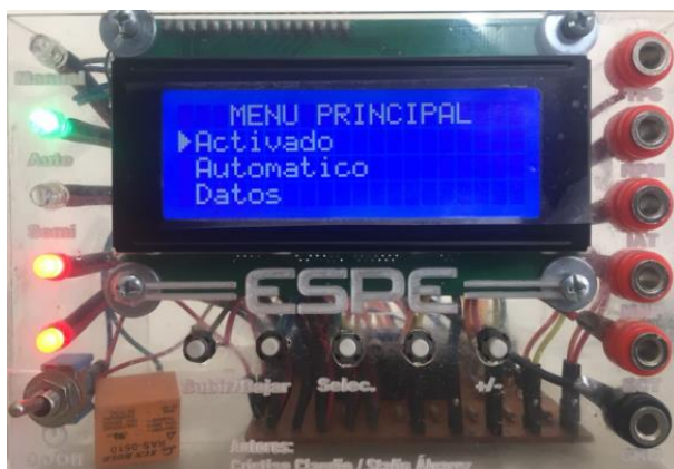
Figura 51. Módulo de control en modo automático
