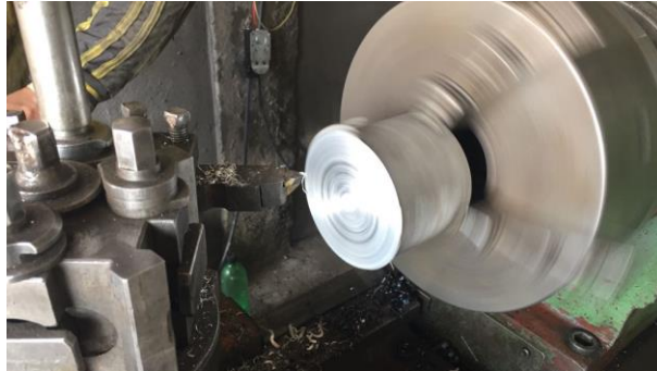
Figura 27. Refrentado de las bases de inyectores
