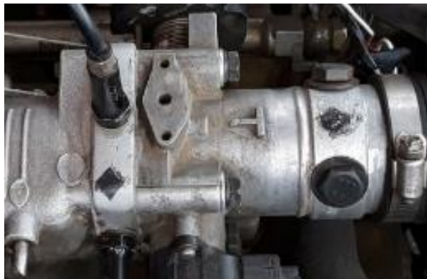
Figura 28. Cuerpo de aceleración implementado la base de inyectores
