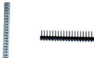
Figura 3.22. Espadines de conexión al cable IDE-26
