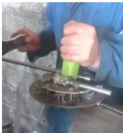
En un tubo de diámetro con relación al grosor del plátano es afilado a su contorno permitiendo mediante el empuje por medio de dos rodillos en su parte superior al producto, dando como resultado mediante la presión ejercida al plátano el descascarado sin importar la forma del producto
