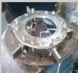
Cuatro cuchillas localizadas al contorno de un disco con ayuda de resortes para su desplazamiento lineal para amoldarse al producto al ser ingresado por la parte superior.
