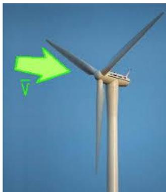
**Figura 4.** Aerogenerador a barlovento
