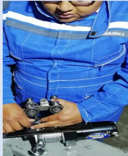
Finalmente se procede a realizar pruebas de funcionamiento instalando un sistema de control que ayudara a ejecutar los movimientos verticales al sistema grúa techo.
