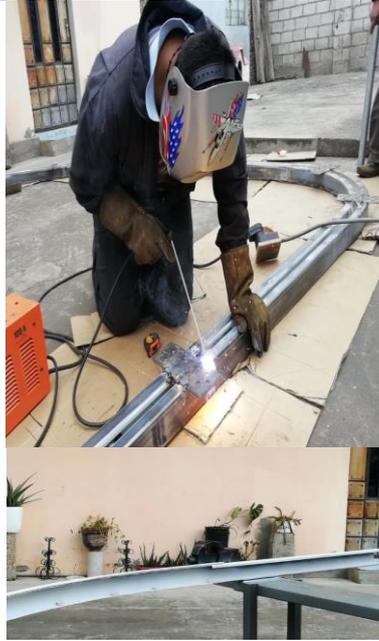
Construida las partes mecánicas de la estructura se procede a unir los raíles y las placas de sujeción con la soldadura SMAW y finalmente se procede a pulir y fondear con pintura el sistema grúa techo.
