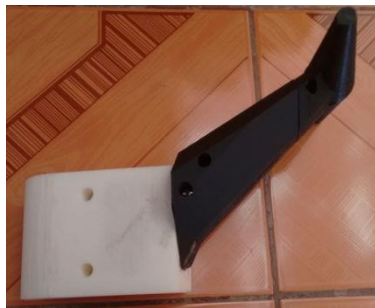
Figura 113 Ensamble del eslabón Cola
