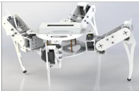
Figura 5 Plataforma Robótica Zoomórfica de cuatro extremidades con doce grados de libertad desarrollada en la Universidad de las Fuerzas Armadas “ESPE”
