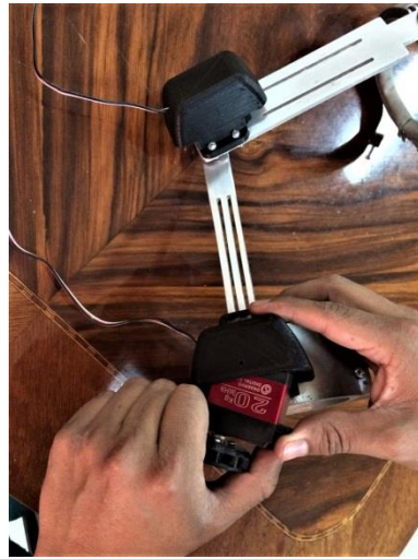
Figura 124. Implementación de los actuadores en el exoesqueleto
