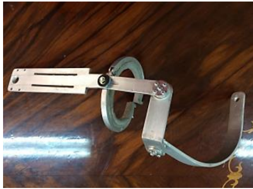
Figura 90. Sección del hombro-brazo totalmente implementada
