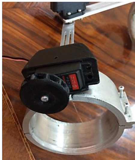
Figura 91. Soporte servomotor implementado
