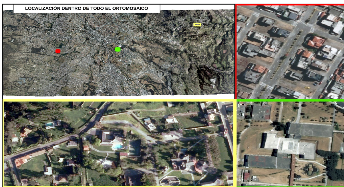
Figura 155. Ortomosaico con ajuste de líneas de vuelo y 13 GCP en Orima.
