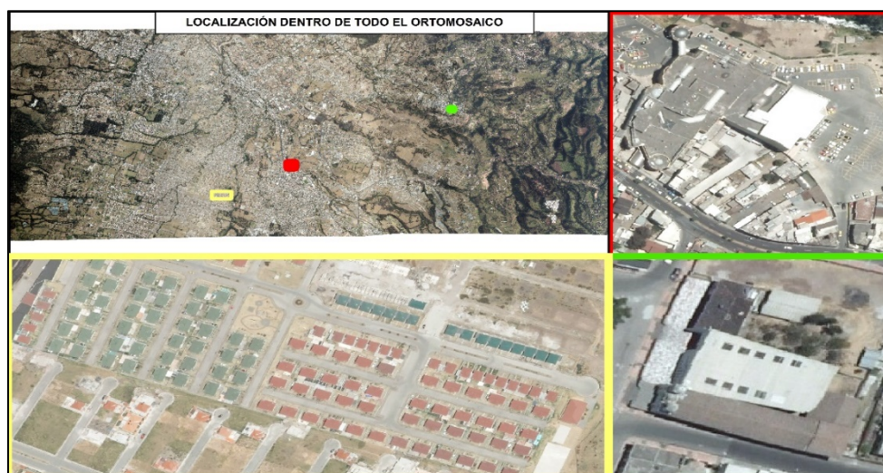
Figura 158. Ortomosaico con 13 GCP y ajuste en bloque con Z/I Imagine.
