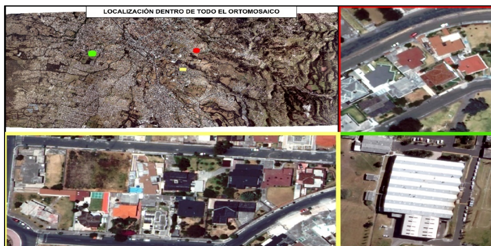
Figura 157. Ortomosaico con ajuste en líneas de vuelo y 19 GCP en Orima
