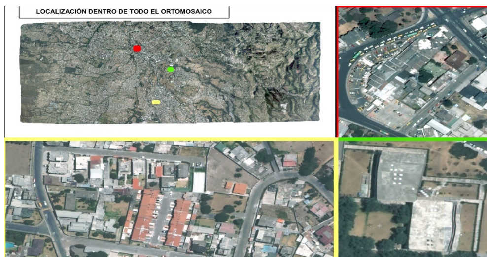
Figura 154. Ortomosaico con ajuste en bloque y 13 GCP en Orima
