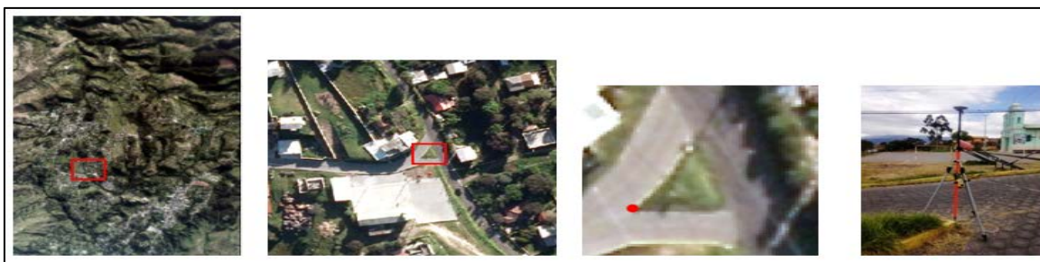
Figura 49. Ejemplo de la ubicación de un punto de control fotogramétrico
