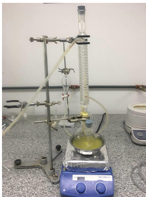
Figura 20. Sistema empleado para la producción de metil ésteres.
