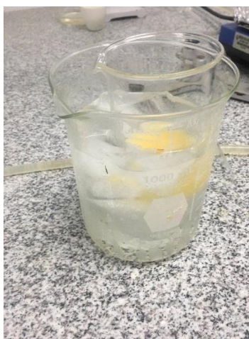
Figura 21. Sistema empleado para el parado de la reacción a los tiempos t_1 , t_2 , t_3 , t_4 y t_5 .
