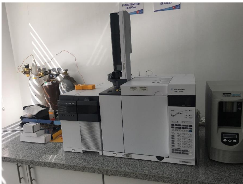
Figura 17. Cromatógrafo Agilent Technologies 7890A GC acoplado al Espectrómetro de masas Agilent Technologies 5977A MSD.
