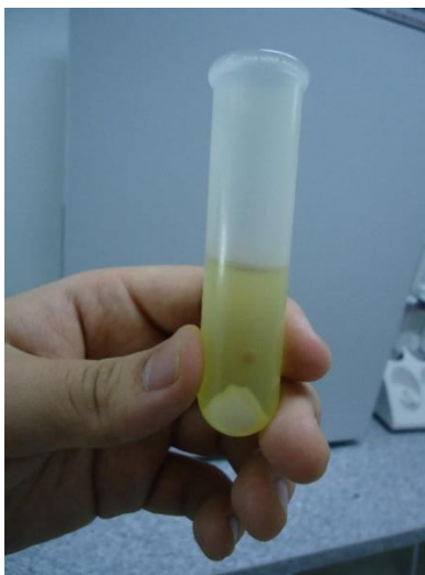
Figura 22. Muestra centrifugada (Separación de fases)
