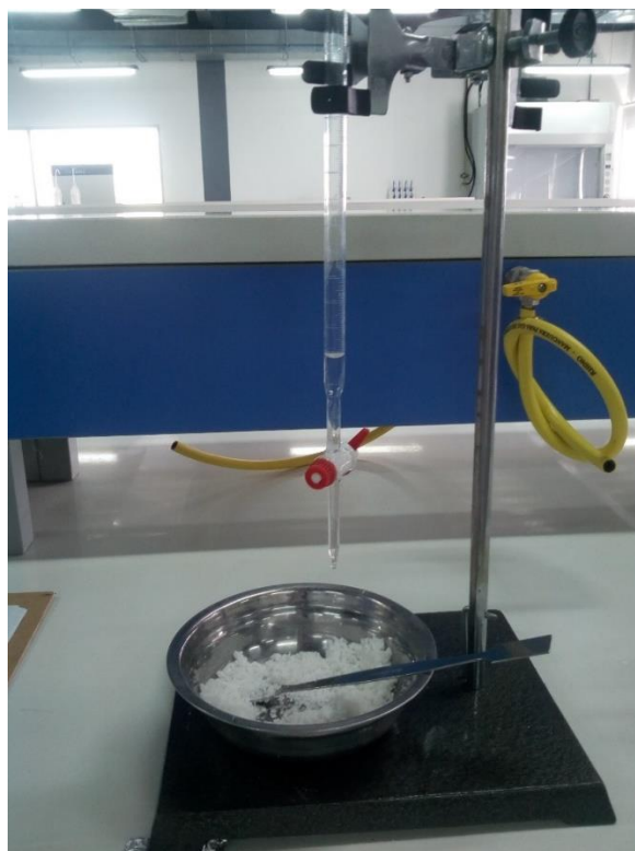
Figura 18. Sistema empleado en la determinación de volumen de poro.
