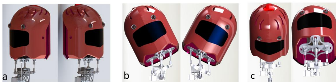
Figura 5 Funcionamiento del mecanismo de 3 GDL. (a) Movimiento en el eje Z, (b) Movimiento en el eje X, (c) Movimiento en el eje Y
