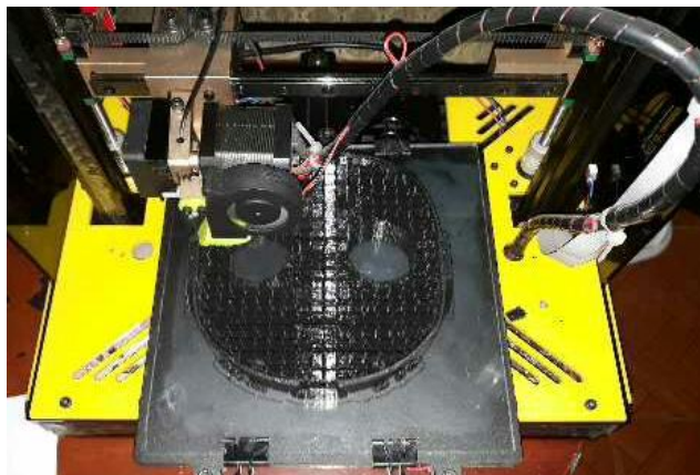
Figura 56 Impresión 3D de la estructura externa del robot.
