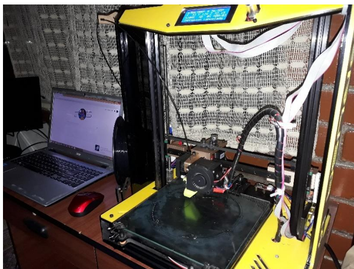
Figura 50 Impresión 3D de la estructura interna del robot.
