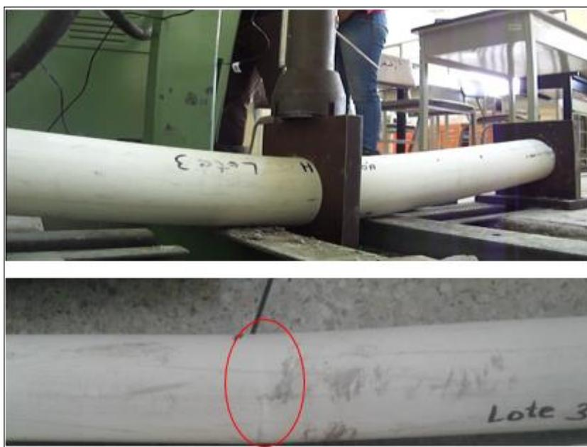
**Figura 71** Falla de probeta de hormigón+PVC
