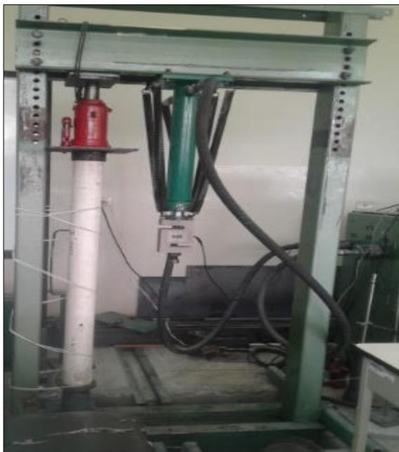
**Figura 49** Ensayo a compresión de columna
