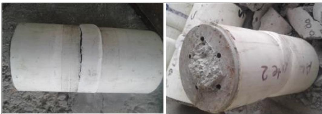
**Figura 112** Falla por corte de hormigón con armadura longitudinal y PVC
