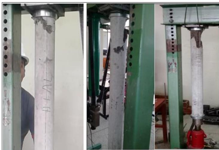
**Figura 95** Falla de columna con armadura longitudinal
