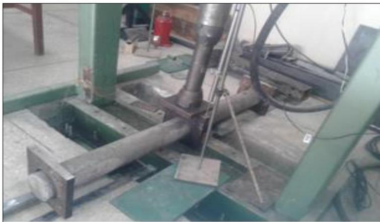
**Figura 68** Ensayo y falla a flexión de probeta de hormigón
