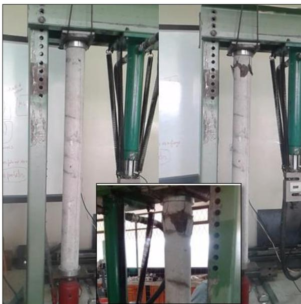
**Figura 97** Falla de columna zunchada
