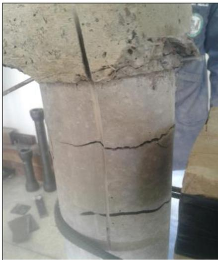
**Figura 64** Fallas durante el ensayo a flexocompresión
