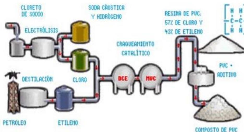
**Figura 5** Proceso de fabricación del PVC
