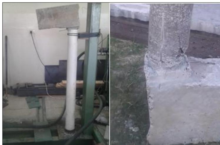
**Figura 124** Falla a flexocompresión para hormigón+aramadura longitudinal más zuncho y PVC
