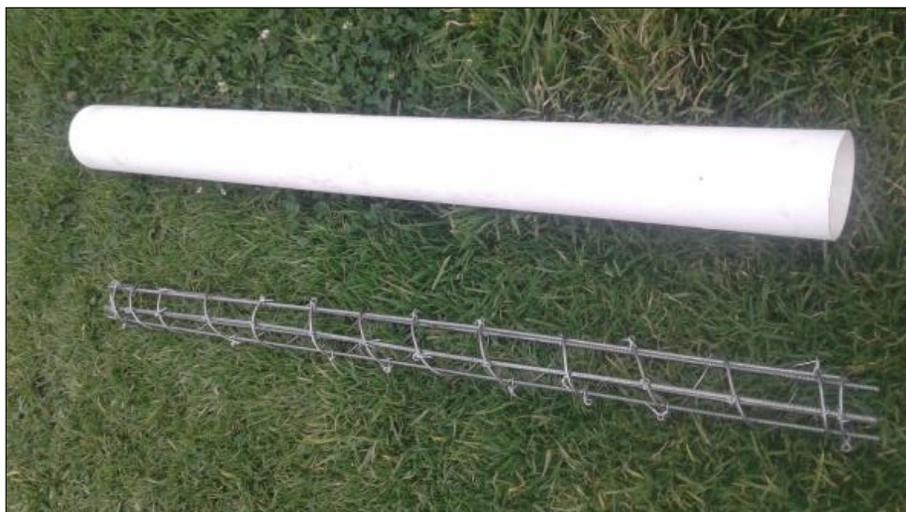
**Figura 41** Armadura de columna y tubo de PVC cortado
