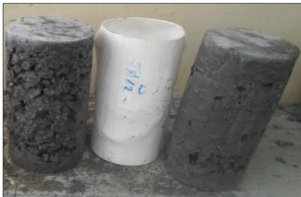
**Figura 86** Hormigòn +PVC+5  $\phi$  12 con estribos
