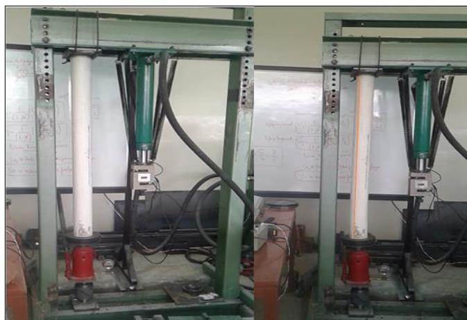
**Figura 94** Falla de columna de hormigón simple+PVC
