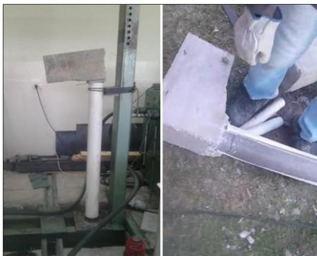
**Figura 122** Falla a flexo-compresión de columna de hormigón con armadura longitudinal y PVC
