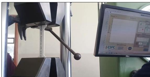
**Figura 59** Ensayo a tracción de PVC
