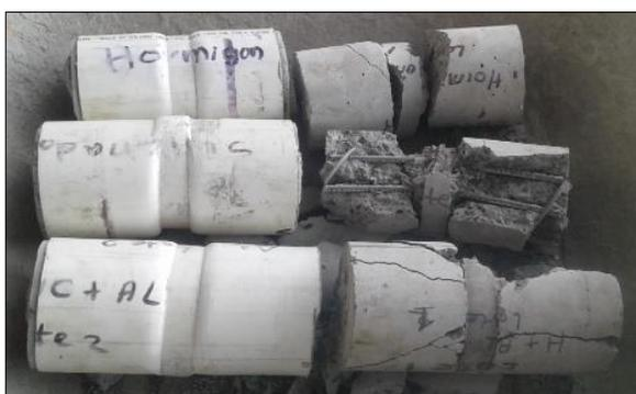
*Figura 55* Probetas ensayadas a corte directo
