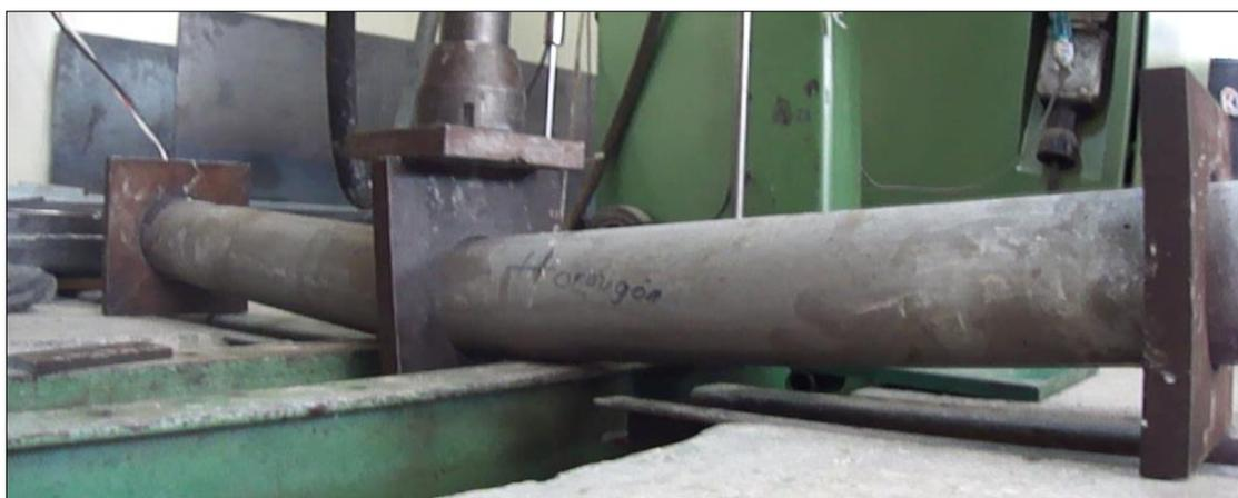
**Figura 69** Falla de probeta de hormigón simple ensayada a flexión
