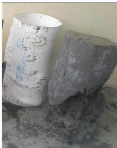
**Figura 84** Falla de probeta armada con 6  $\phi$  10
