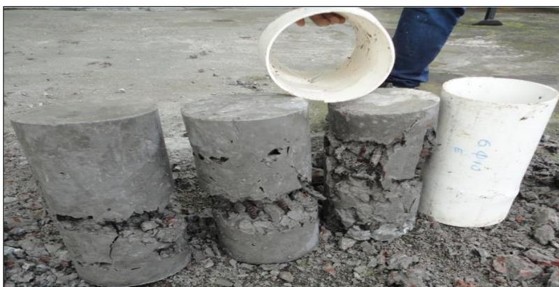
*Figura 88* Falla de probetas armadas con 6  $\phi$  10 y estribos
