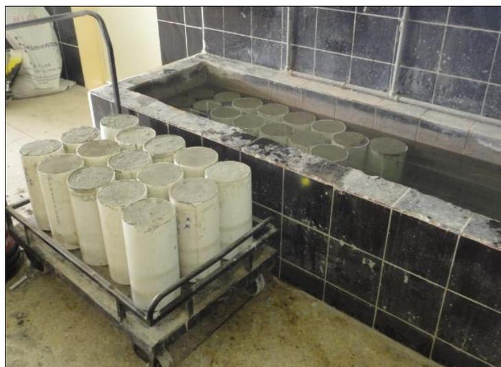
*Figura 34* Curado de probetas y testigos
