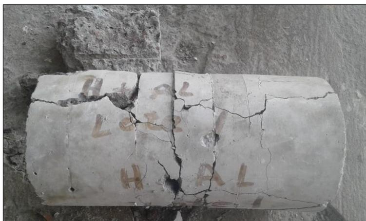
**Figura 110** Falla por corte de hormigón + AL.
