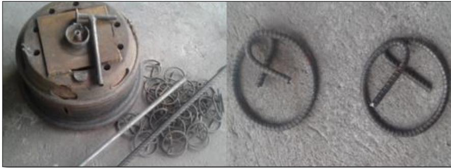
**Figura 29** Construcción de estribos
