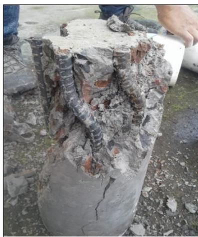
**Figura 83** Falla a compresión de hormigón + PVC+4 φ 10
