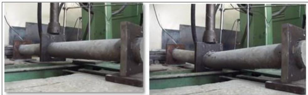
**Figura 73** Falla de probeta de hormigón con armadura longitudinal
