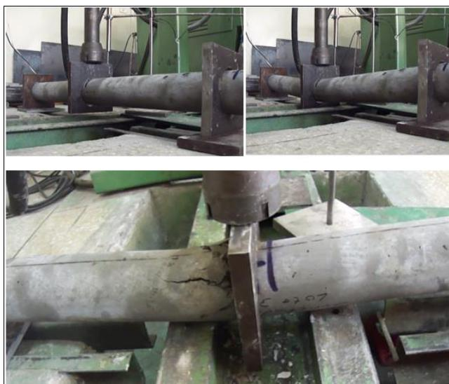
**Figura 77** Falla de columna de hormigón armado + zuncho
