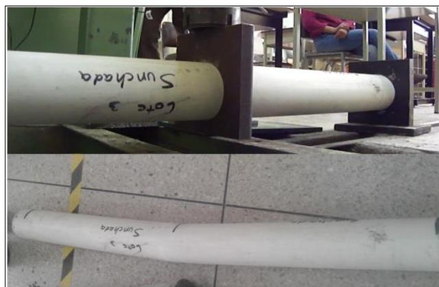
**Figura 79** Falla de la probeta zunchada + PVC
