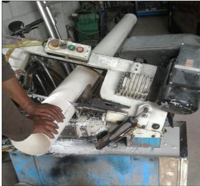
**Figura 28** Corte de tubos de PVC con cierra continua
