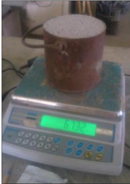
*Figura 24* Peso volumétrico del agregado fino compactado
