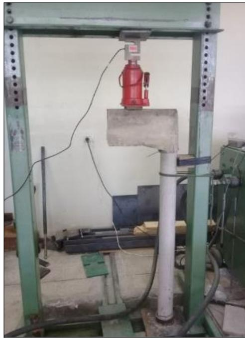
**Figura 63** Ensayo a flexocompresión
