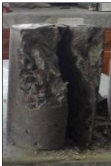
**Figura 81** Falla tipo cónica y dividida
