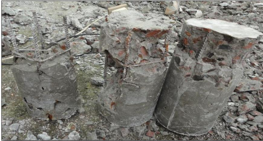
**Figura 91** Falla de probetas armadas con columnas electrosoldadas
