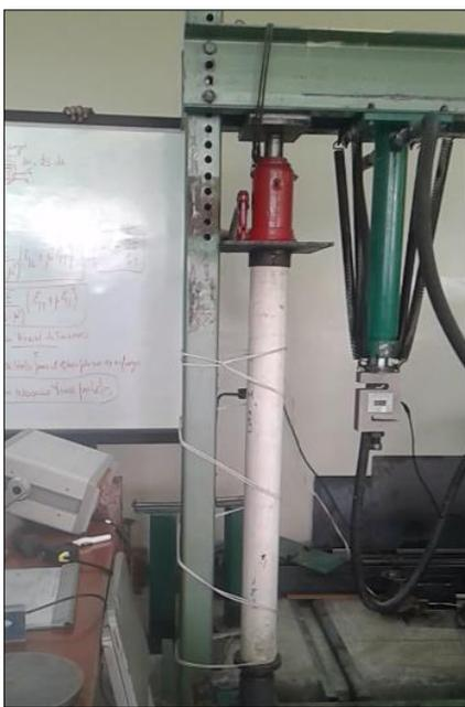
**Figura 96** Columna de hormigón con armadura longitudinal +PVC
