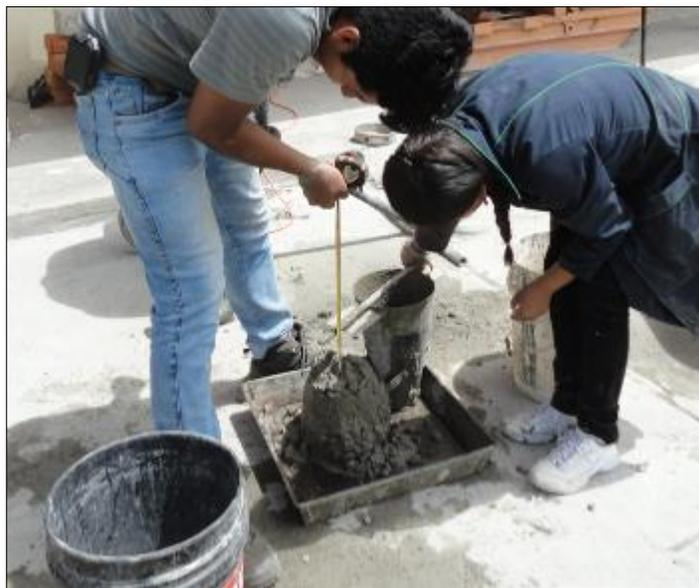
**Figura 32** Ensayo de revenimiento
