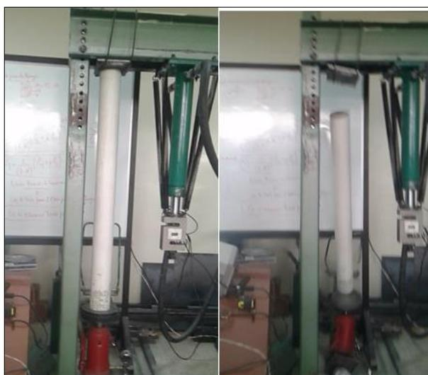
**Figura 98** Columna zunchada + PVC
