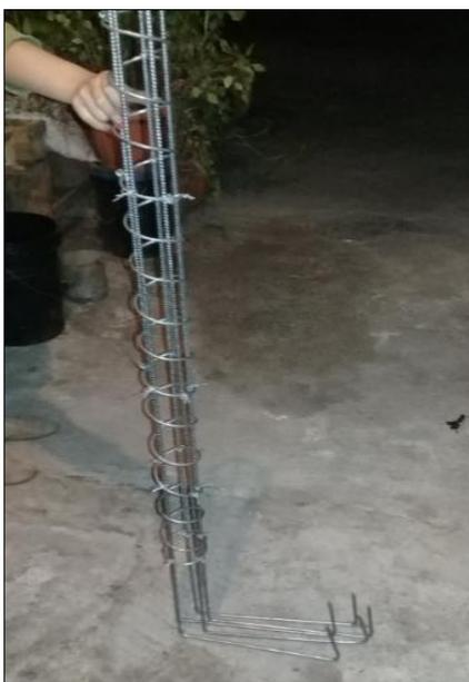
**Figura 46** Armado de probeta
