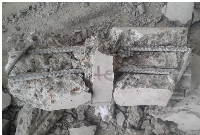
**Figura 114** Falla de probeta zunchada
