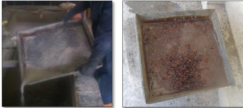
**Figura 23** Lavado de agregado fino y grueso
