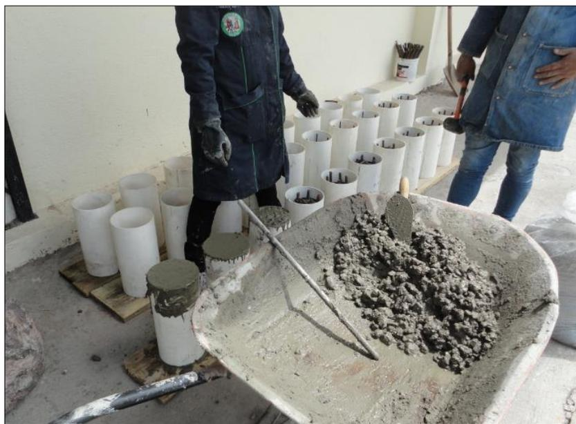
**Figura 33** Vertido del hormigón
