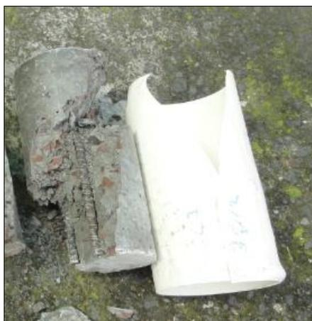
**Figura 85** Falla de probeta con acero longitudinal 3 $\phi$ 12
