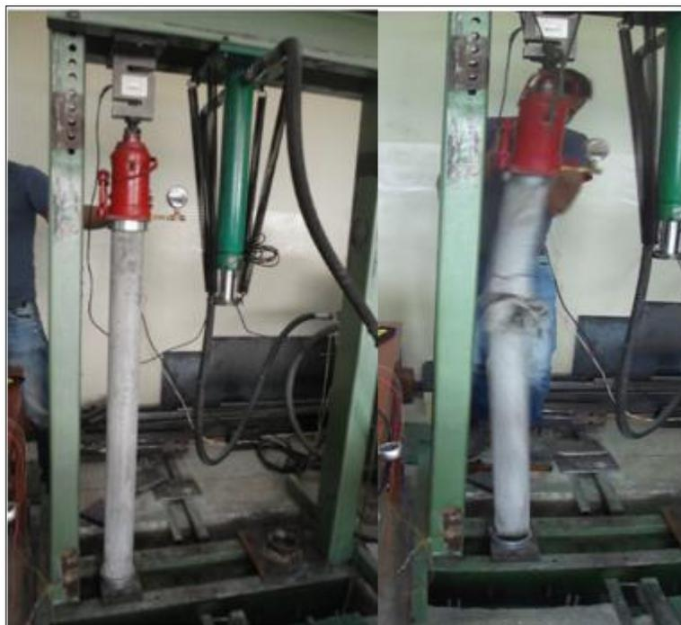
*Figura 93* Falla de columna de hormigón simple
