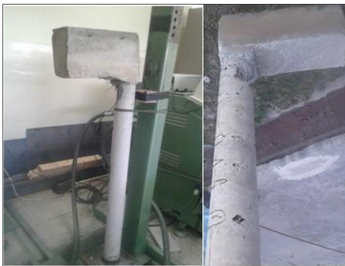
**Figura 121** Falla a flexocompresión de hormigón +AL
