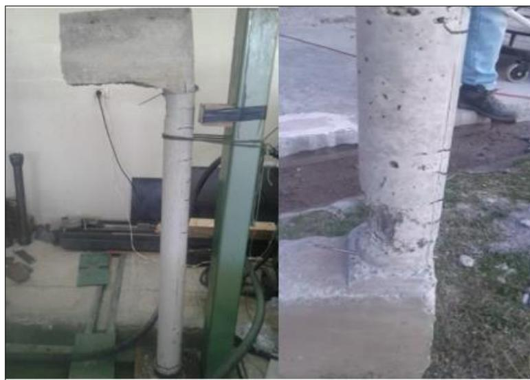
**Figura 123** Falla a flexocompresión de hormigón+Armadura longitudinal+zuncho
