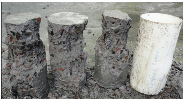
**Figura 89** Falla de probetas armadas con 3  $\phi$  12 y estribos
