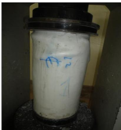
**Figura 82** Probeta fallada hormigón +PVC
