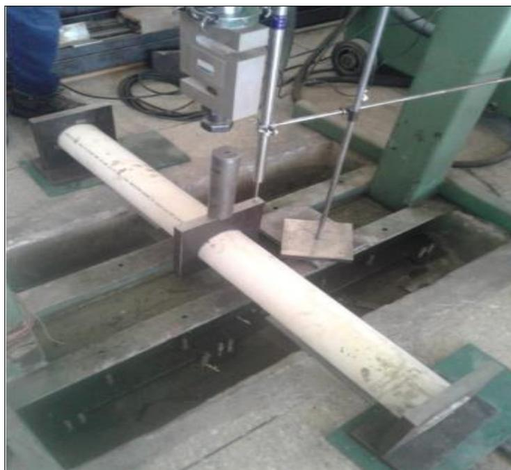
**Figura 70** Ensayo a flexión de probeta de hormigón +PVC
