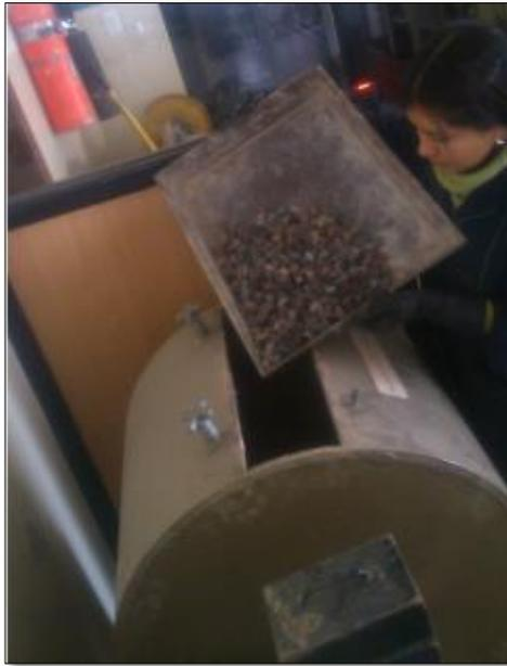
**Figura 25** Colocación del agregado grueso en la máquina de los Ángeles
