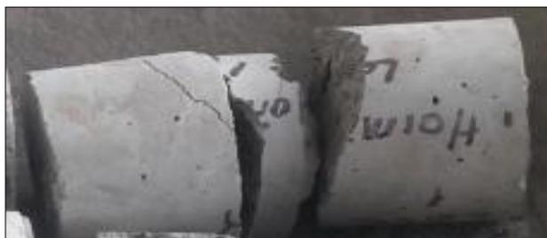
**Figura 107** Falla por corte del hoirmigón
