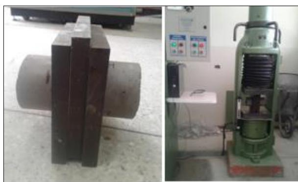
*Figura 54* Corte directo del hormigón
