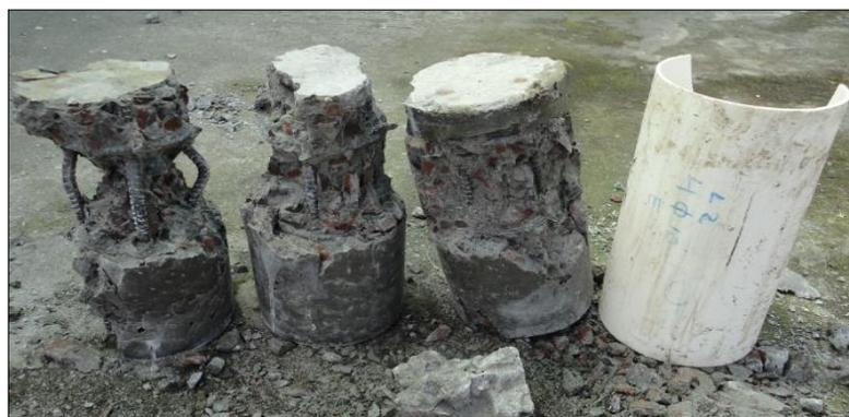
**Figura 87** Falla de probeta armada con 4  $\phi$  10 con estribos
