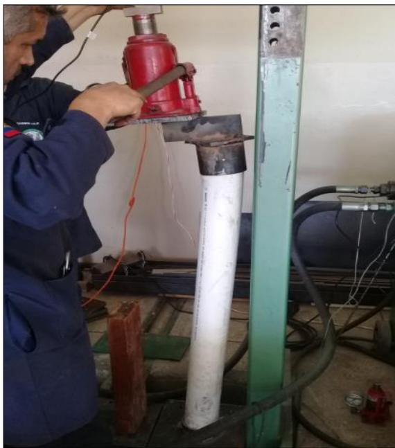
**Figura 44** Aplicación de carga excéntrica
