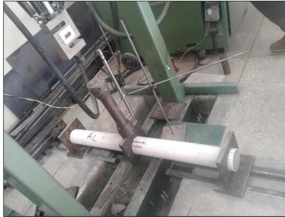
**Figura 53** Ensayo a flexión
