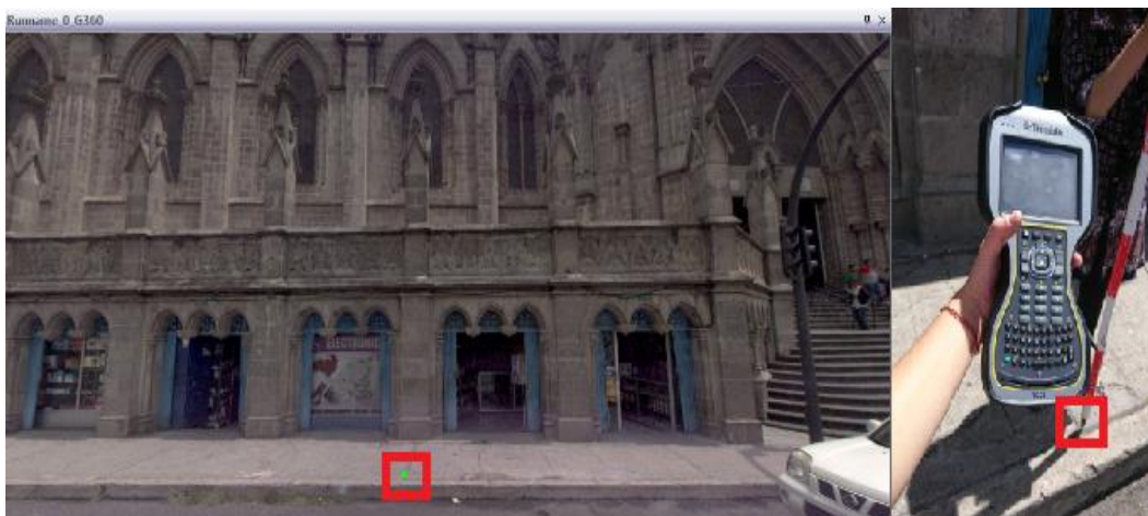
Figura 22. Punto6-Pinchado en la foto (izquierda) -Pinchado en el terreno (derecha)
