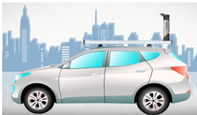
Figura 2. Equipo Trimble MX7 montado en un vehículo. Fuente: ( Óptica , 2015)
