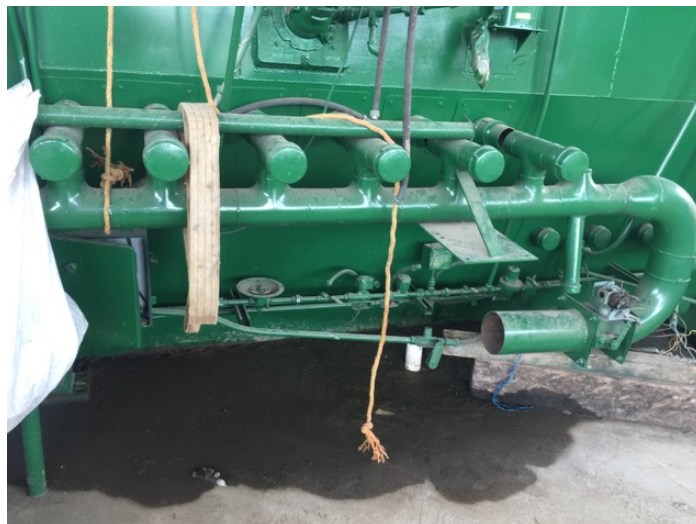
Figura 14. Sistema de distribución de aire
