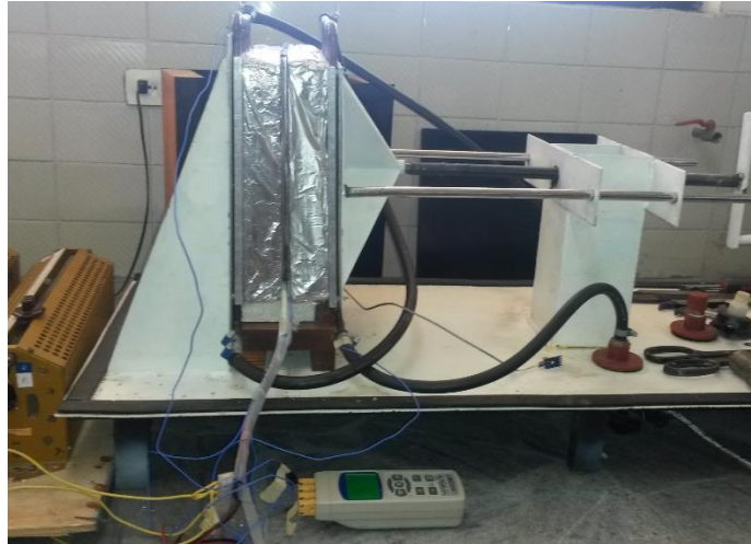
Figura 22. Máquina de Conductividad Térmica Fuente: (Lab. Termodinámica, UFA-ESPE, 2018)
