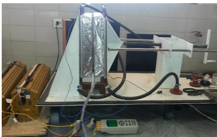
Figura 6. Equipo de Conductividad Térmica Fuente: (Lab. Termodinámica UFA-ESPE, 2018)
