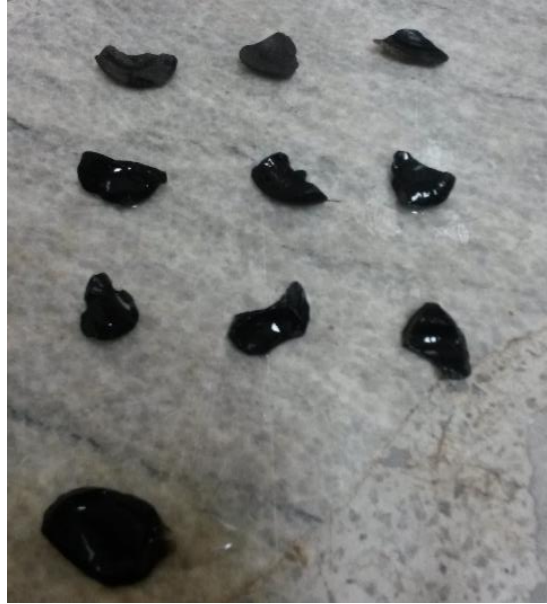
Figura 20. Muestras de cuesco saturadas Fuente: (Lab. Ensayo Materiales UFA-ESPE, 2018)
