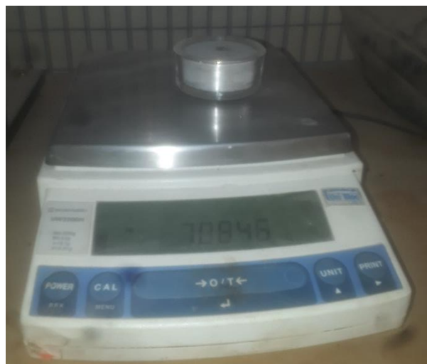
Figura 56. Masa de mercurio y recipiente Fuente: (Lab. Ensayo Materiales, UFA-ESPE, 2018)
