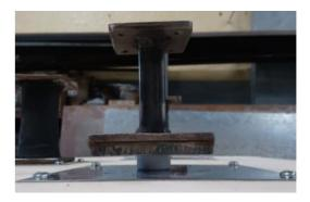
Figura 68. Aislador sísmico friccional para el prototipo SHAB
