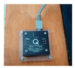
Figura 74. Acelerómetro en mesa vibratoria
