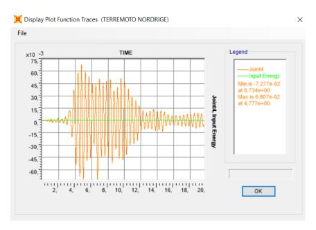
*Figura 123.* Acelerograma Tiempo - Historia en X del terremoto de Northridge obtenidos del modelamiento en el software
