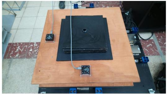
Figura 75. Acelerómetros colocados en el prototipo
