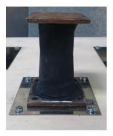
Figura 66. Aislador elastomérico para el prototipo SHAB
