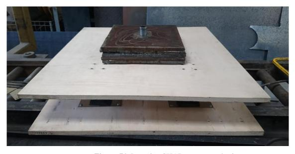
Figura 71. Prototipo SHAB con masa sísmica
