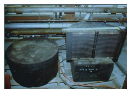
*Figura 30.* Construcción interna de un aislador elastomérico Fuente: (M.C. Constantinou, A.S. Whittaker, Y. Kalpakidis, D.M. Fenz, 2007)
