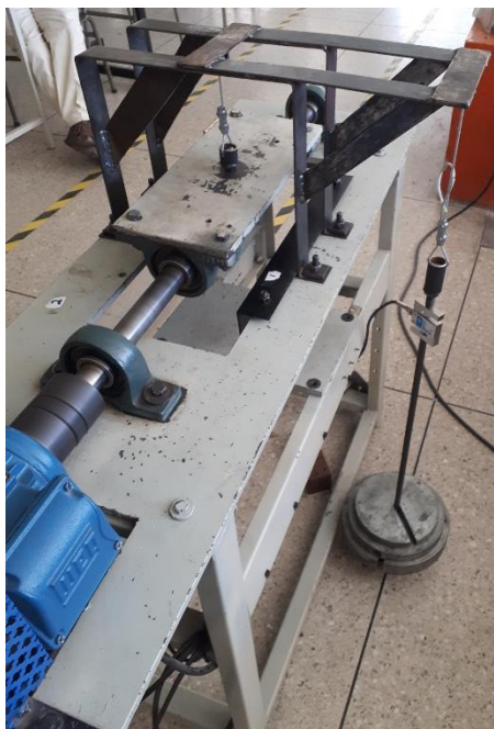
Figura 65. Ensayo de Fatiga con soporte de precarga.
