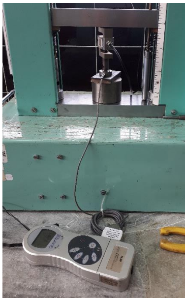
Figura 33. Calibración de la celda de carga de la máquina.
