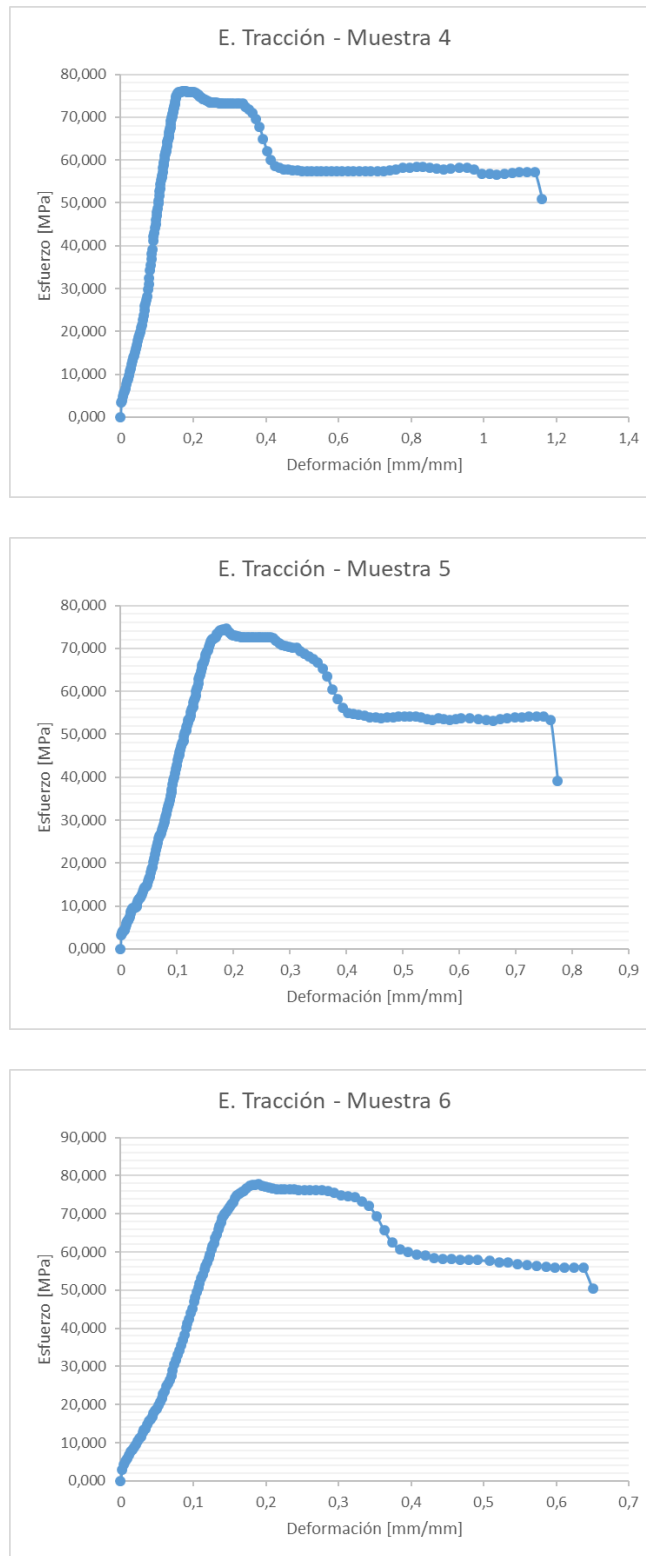
Figura 23. Diagramas esfuerzo de ingeniería – def. unitaria, ensayos de tracción muestras 4-6.
