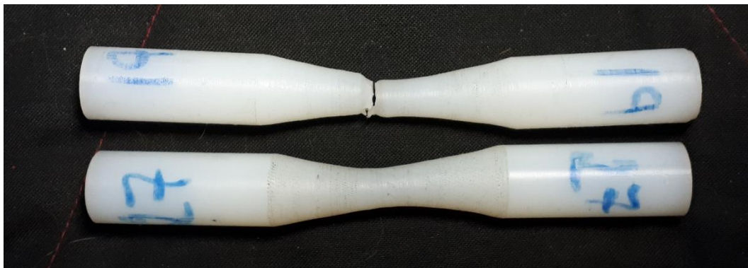
Figura 67. Muestras ensayo de fatiga, fallo por deformación y por rotura.
