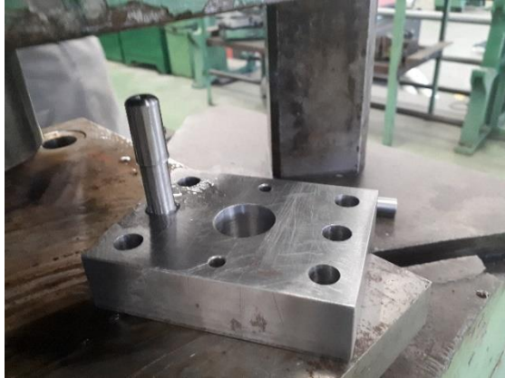
Figura 44. Montaje de guías en matriz superior.
