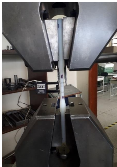
Figura 21. Conjunto montado para ensayo de tracción.
