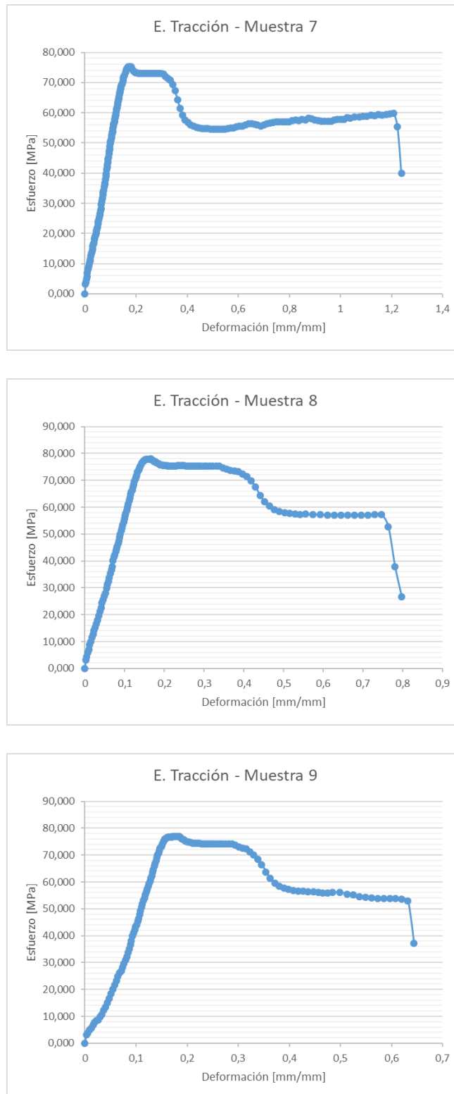
Figura 24. Diagramas esfuerzo de ingeniería – def. unitaria, ensayos de tracción muestras 7-9.
