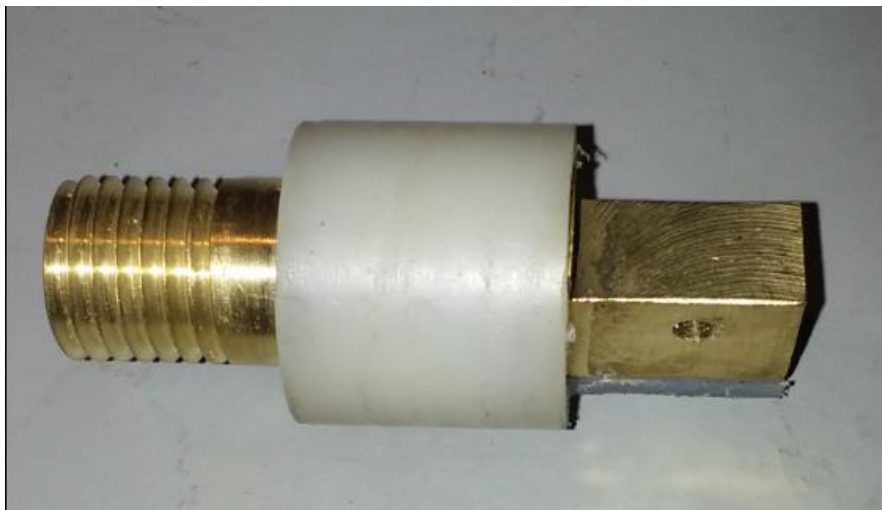
Figura 110: Ensamble aislante con base conexión soporte electrodos
