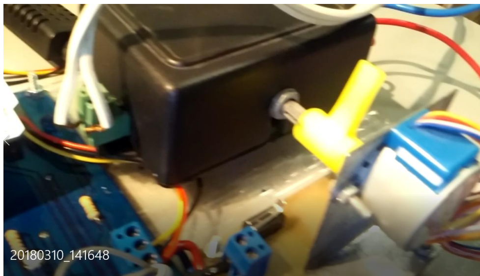
Figura 127: Pruebas de funcionamiento del dimmer y motor a pasos
