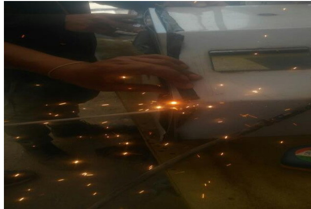
Figura 100: Soldadura de Tapas del equipo
