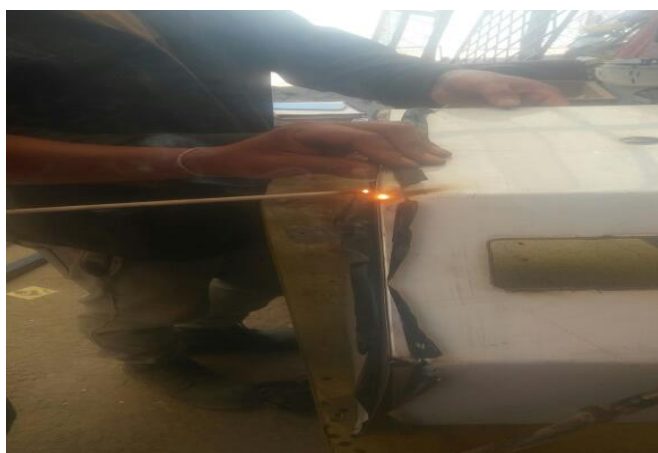
Figura 99: Soldadura de Tapas del equipo
